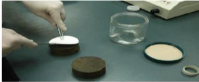
Ilustración 3 Muestra compactada de suelo
