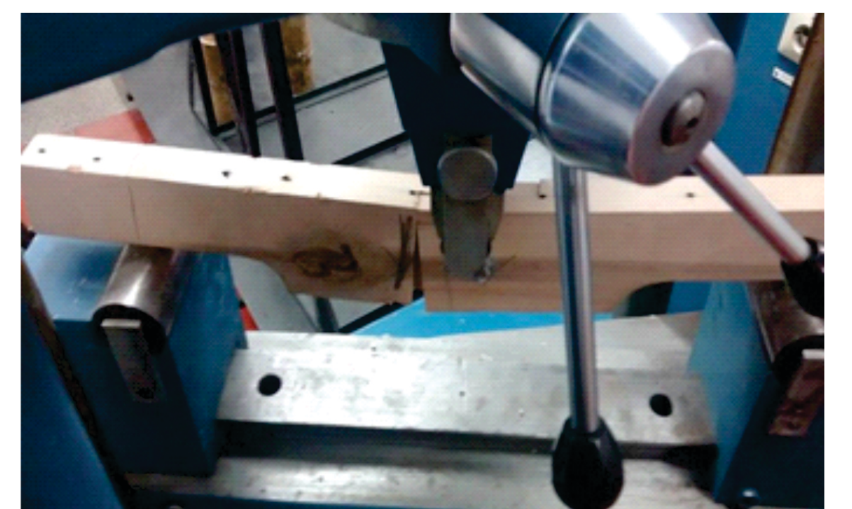
Vista de la falla en el sentido del corte
