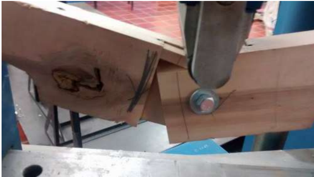
Ilustración 28: Segunda falla bajo una carga de 6.5 KN
