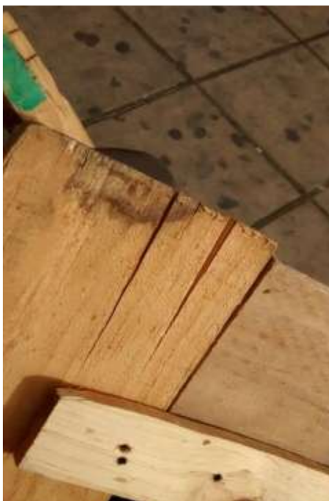
Ilustración 30: Fallas longitudinales por ensayo a flexión
