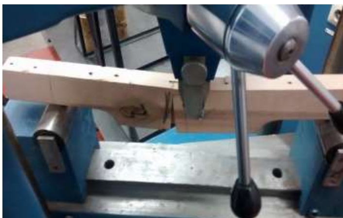
Ilustración 26: Primera falla por flexión
