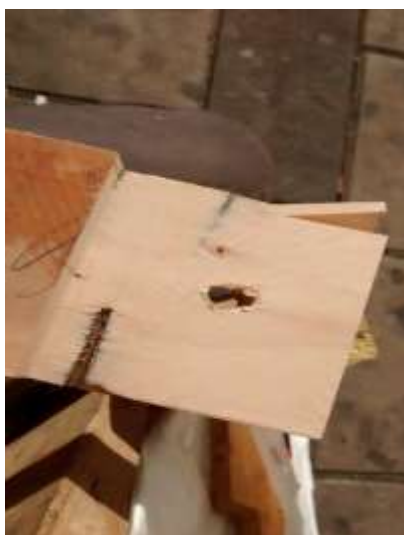
Ilustración 27: Vista de la falla en el sentido del corte
