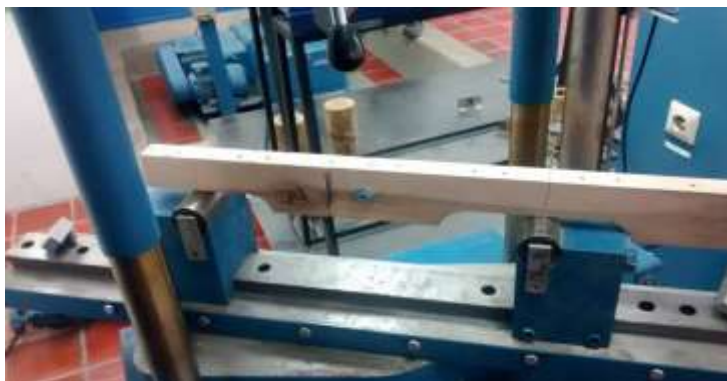
Ilustración 25: Elemento con tornillo pasante previo a su ensayo
