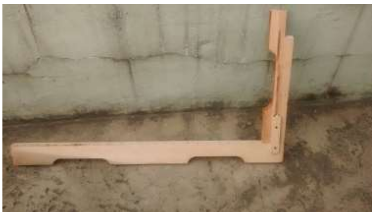
Ilustración 24: Pendolón y tirante en cubierta con refuerzo atornillado
