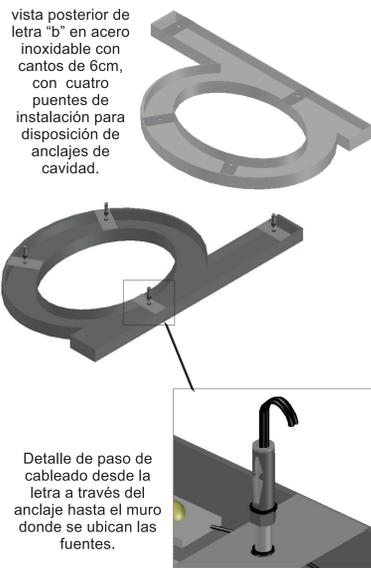
Detalle de paso de cableado desde la letra a través del anclaje hasta el muro donde se ubican las fuentes.
