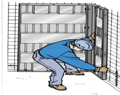
Ilustración 7 Ubicación de muros, forsa
