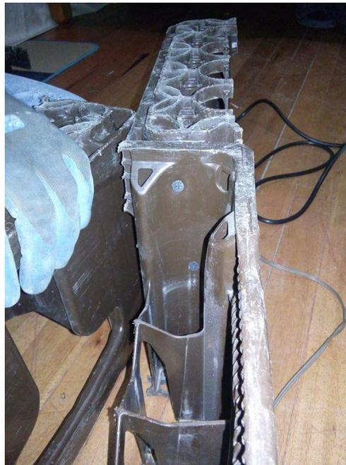
Ilustracion 25 union con 4 tornillos autoperforantes de 1 pulgada Fuente: Elaboracion Propia (2015)
