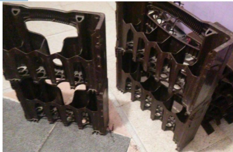
Ilustracion 10. Corte realizado con segueta de manera transversal (Por su lado mas angosto) Elaboracion Propia 2015
