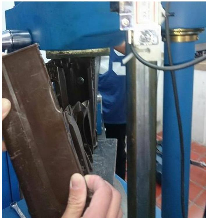
Ilustracion 23 ensayo a la unión planteada de perno con tuerca y arandela fuente: Elaboracion Propia (2015)
