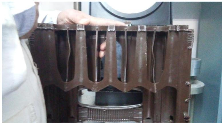
Ilustracion 17. Deformacion luego del ensayo a compresión Fuente : Elaboracion Propia (2015)
