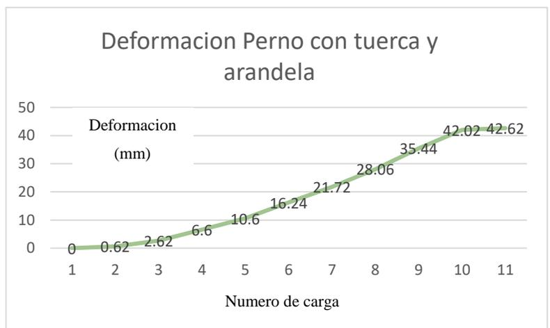
Grafica 6 se muestra la deformación alcanzada por esta unión llegando a su deformación elástica Fuente: Elaboracion Propia (2015)
