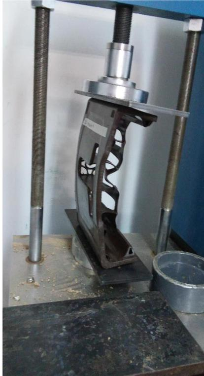
Ilustracion 19. Deformación luego del ensayo a compresión Fuente: Elaboracion Propia (2015)
