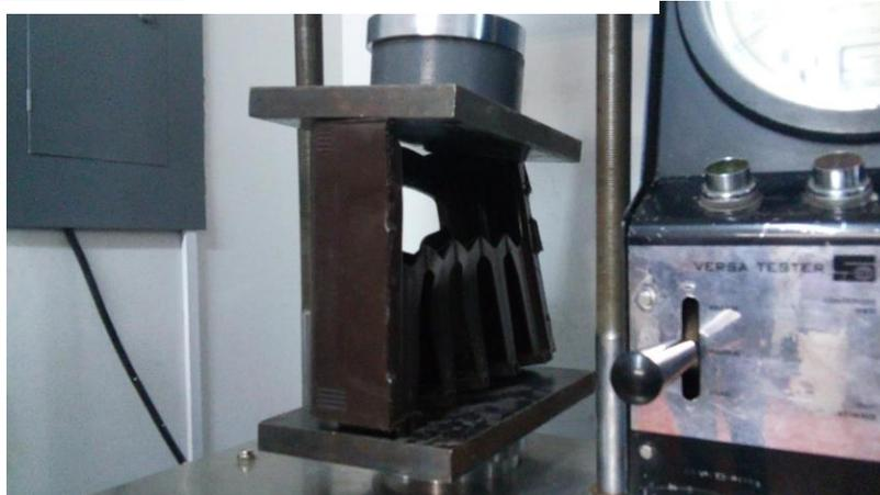
Ilustracion 15 Deformacion luego del ensayo a compresión Fuente : Elaboracion Propia (2015)
