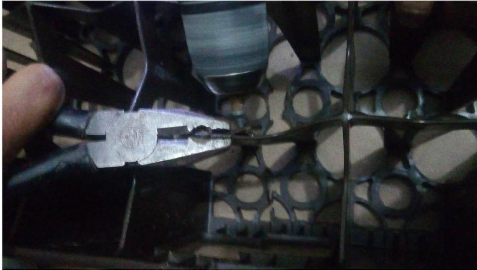
Ilustracion 34. Se puede observar la unión realizada con la ayuda de una atornilladora inalámbrica y un alicate al tratar de traspasar las pestañas de la reticula Autor: Elaboracion Propia (2015)
