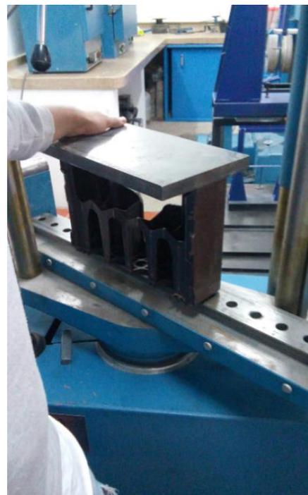
Ilustracion 14. ensayo con la reticula dispuesta en la parte inferior de la sección también, se dan a conocer las medidas finales del elemento Autor: Elaboracion Propia (2015)
