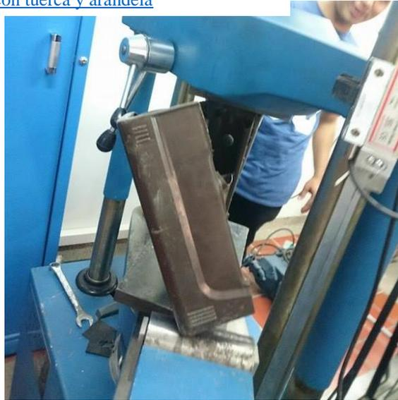
Ilustracion 24 Falla de la unión hecha por perno con tuerca y arandela Fuente: Elaboracion Propia (2015)
