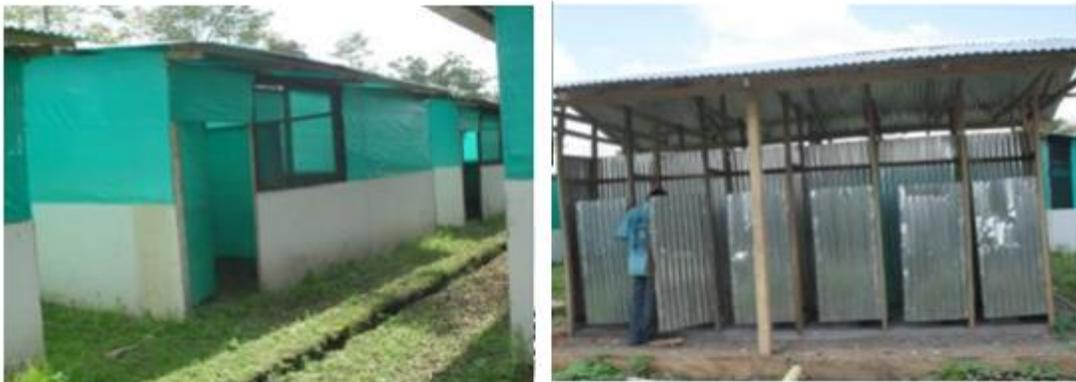
Ilustración 2. Se puede observar un tipo de albergue construido en material de polisombra y perfiles en madera para una Fuente: (Comfenalco Cartagena, 2012). *Proyecto construcción de albergues temporales* p.7 (Consultado 2/09/2015). Recuperado de <http://goo.gl/zU17jr>
