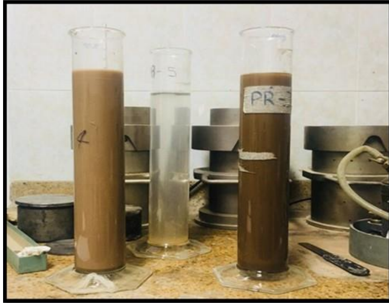
Figura 8. Ensayo de granulometría por hidrómetro
