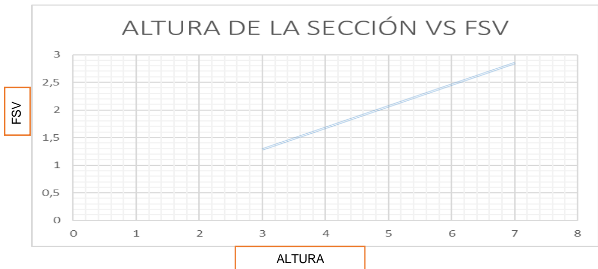
Gráfica altura de la sección rectangular VS factor de seguridad por volcamiento.
