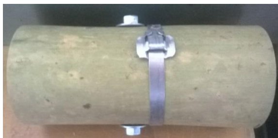
Ilustración 8 Guadua con Perno y Zuncho
