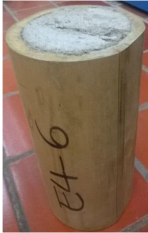
Ilustración 13 Guadua rellena con Mortero
