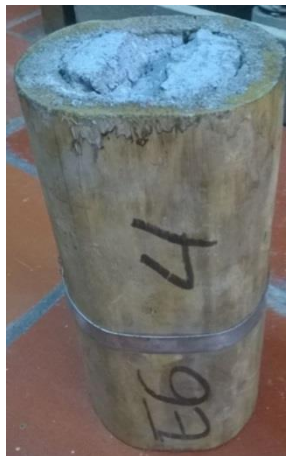
Ilustración 15 Guadua + Mortero + Zuncho
