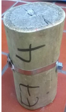
Ilustración 16 Guadua + Mortero + Perno + Zuncho
