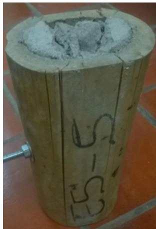
Ilustración 14 Guadua rellena con Mortero y reforzada con Perno
