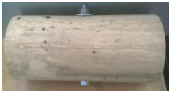
Ilustración 7 Guadua con Perno
