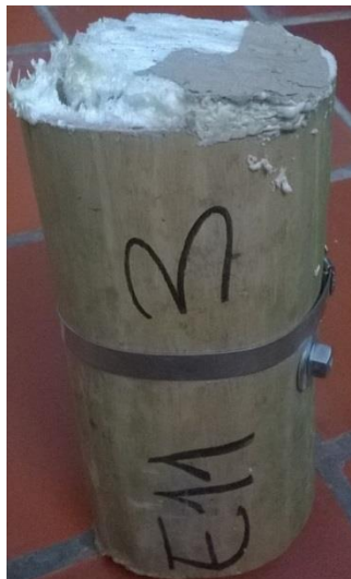
Ilustración 21 Guadua + Poliuretano + Perno + Zuncho
