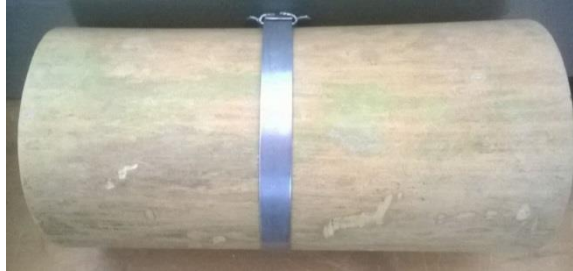
Ilustración 6 Guadua con Zuncho metálico
