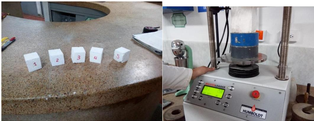
Para el poliestireno expandido se evidencia que los ensayos realizados en el laboratorio fueron elaborados en la maquina Humboldt con muestras del material icopor, de donde se tomaron datos guardados en el mismo equipo.
