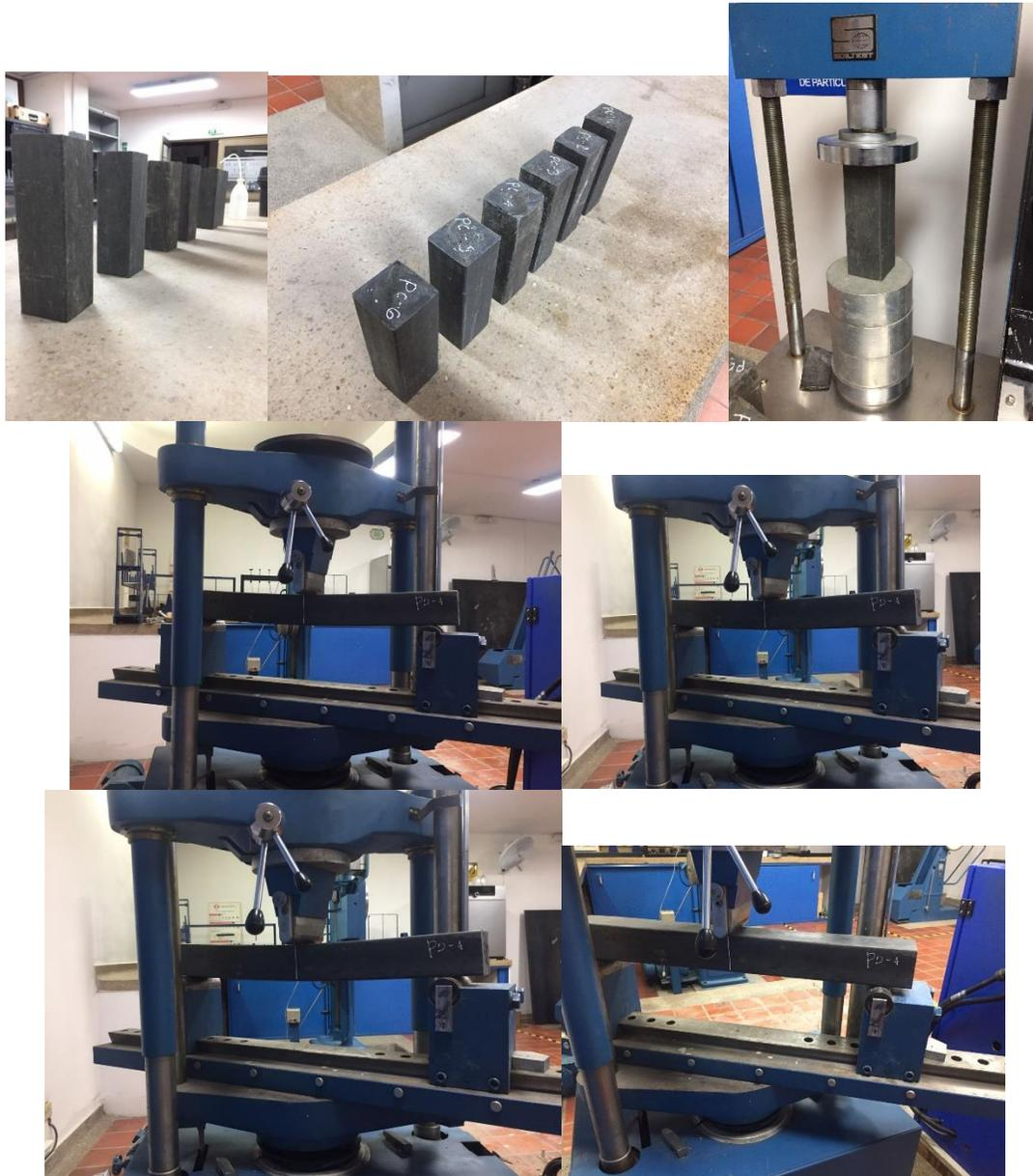
Para los ensayos realizados con el Tereftalato de polietileno se muestra que estos fueron realizados en similitud a los del pino, como se evidencia este material sufre deformaciones desconsideración.
