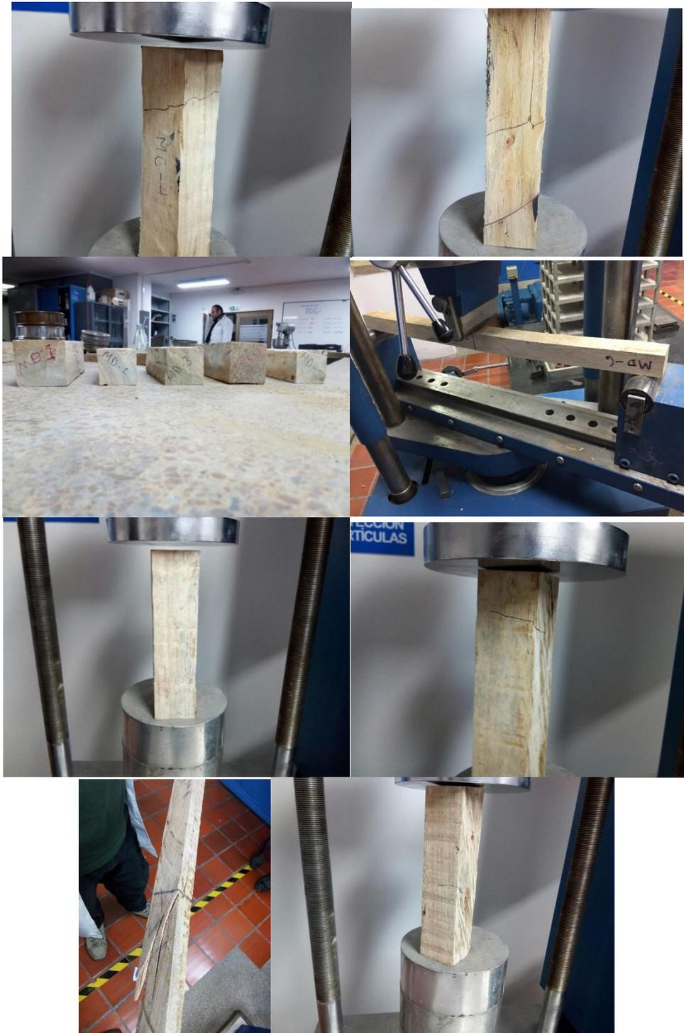
Las muestras de madera que se muestran anteriormente demuestran la aplicación de ensayos de compresión y flexión bajo parámetros de carga.
