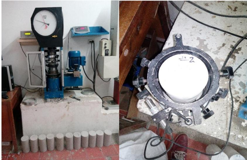
Posteriormente se llevaron a la falla los cilindros para determinar su resistencia ultima o total.
