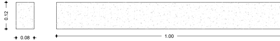
SECCION LONGITUDINAL Y TRANSVERSAL DE LA VIGA
