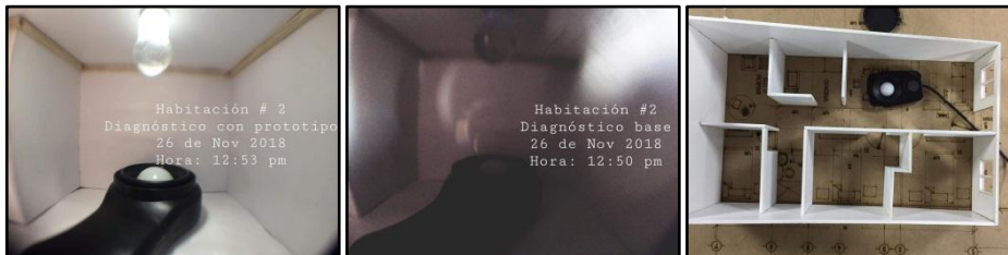
Ilustración 62. Posición del luxómetro para obtención correcta de los indicadores. Tomado de: Fuente propia.
