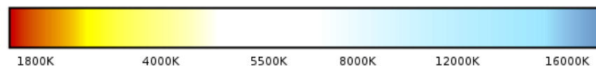
Ilustración 19. Escala de temperatura de colores en unidad de medida grados Kelvin Tomada de (Muchos Leds, 2018.p.2)
