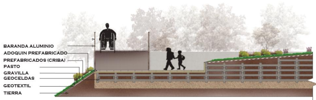
Figura 38 Muros de Criba
