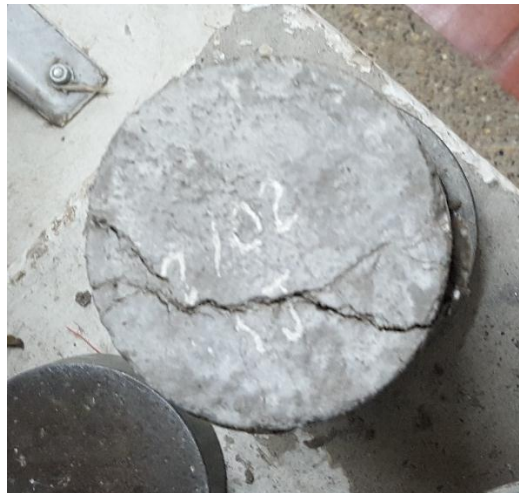
Fotografía 2. Fotografía tipo de fractura tipo 5
