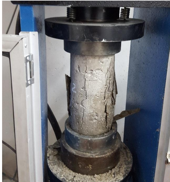
Fotografía 6. Fotografía tipo de fractura tipo 3
