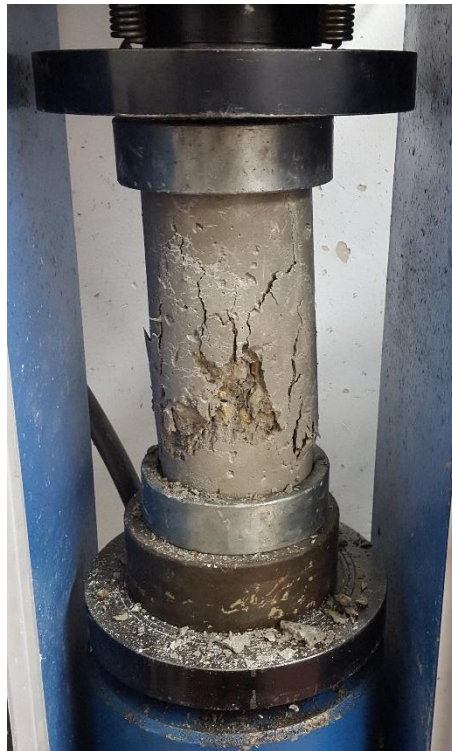
Fotografía 14. Fotografía tipo de fractura tipo 1
