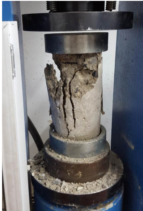
Fotografía 16. Fotografía tipo de fractura tipo 5
