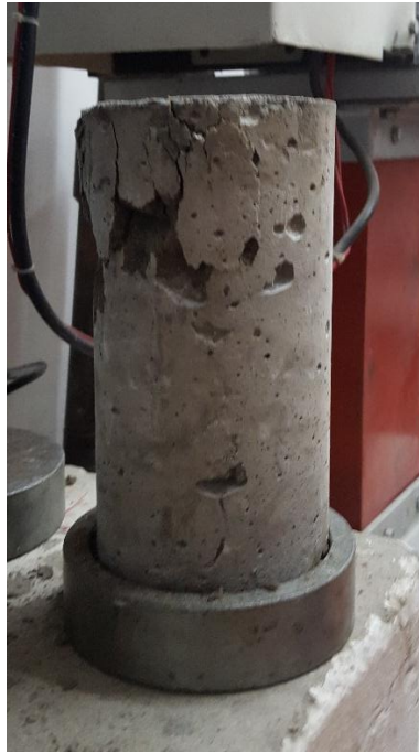
Fotografía 1 Fotografía tipo de fractura tipo 5
