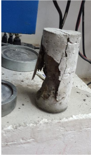
Fotografía 9. Fotografía tipo de fractura tipo 2
