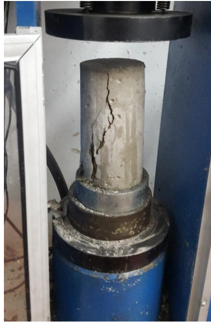
Fotografía 15. Fotografía tipo de fractura tipo 3
