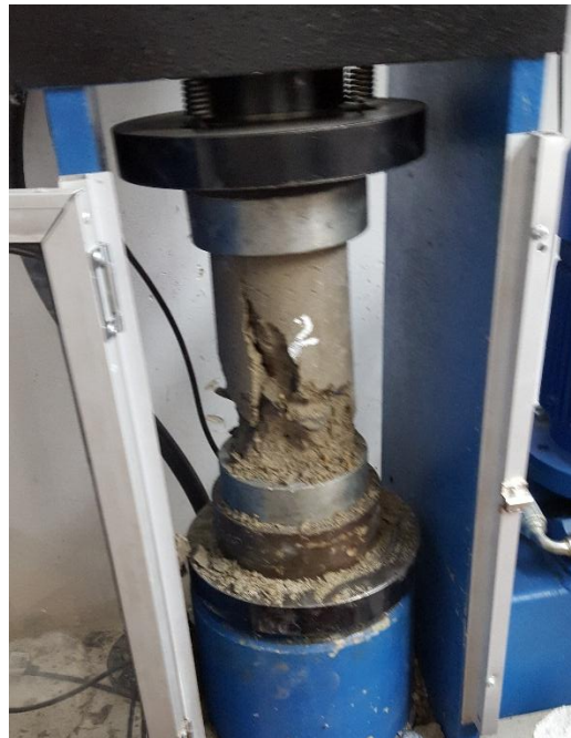
Fotografía 4. Fotografía tipo de fractura tipo 4
