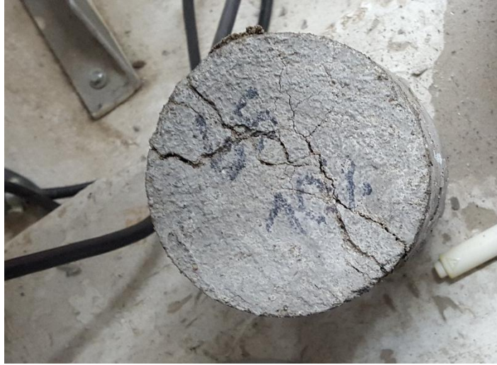
Fotografía 11. Fotografía tipo de fractura tipo 3
