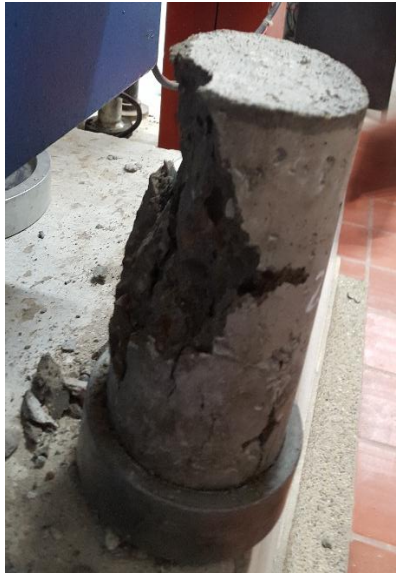
Fotografía 7. Fotografía tipo de fractura tipo 2
