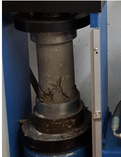
Fotografía 3. Fotografía tipo de fractura tipo 5
