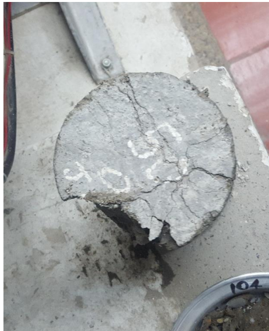
Fotografía 8. Fotografía tipo de fractura tipo 6
