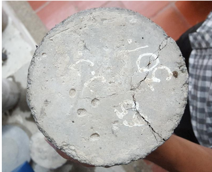
Fotografía 13. Fotografía tipo de fractura tipo 5
