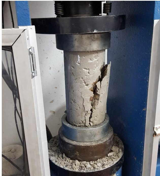
Fotografía 10. Fotografía tipo de fractura tipo 2
