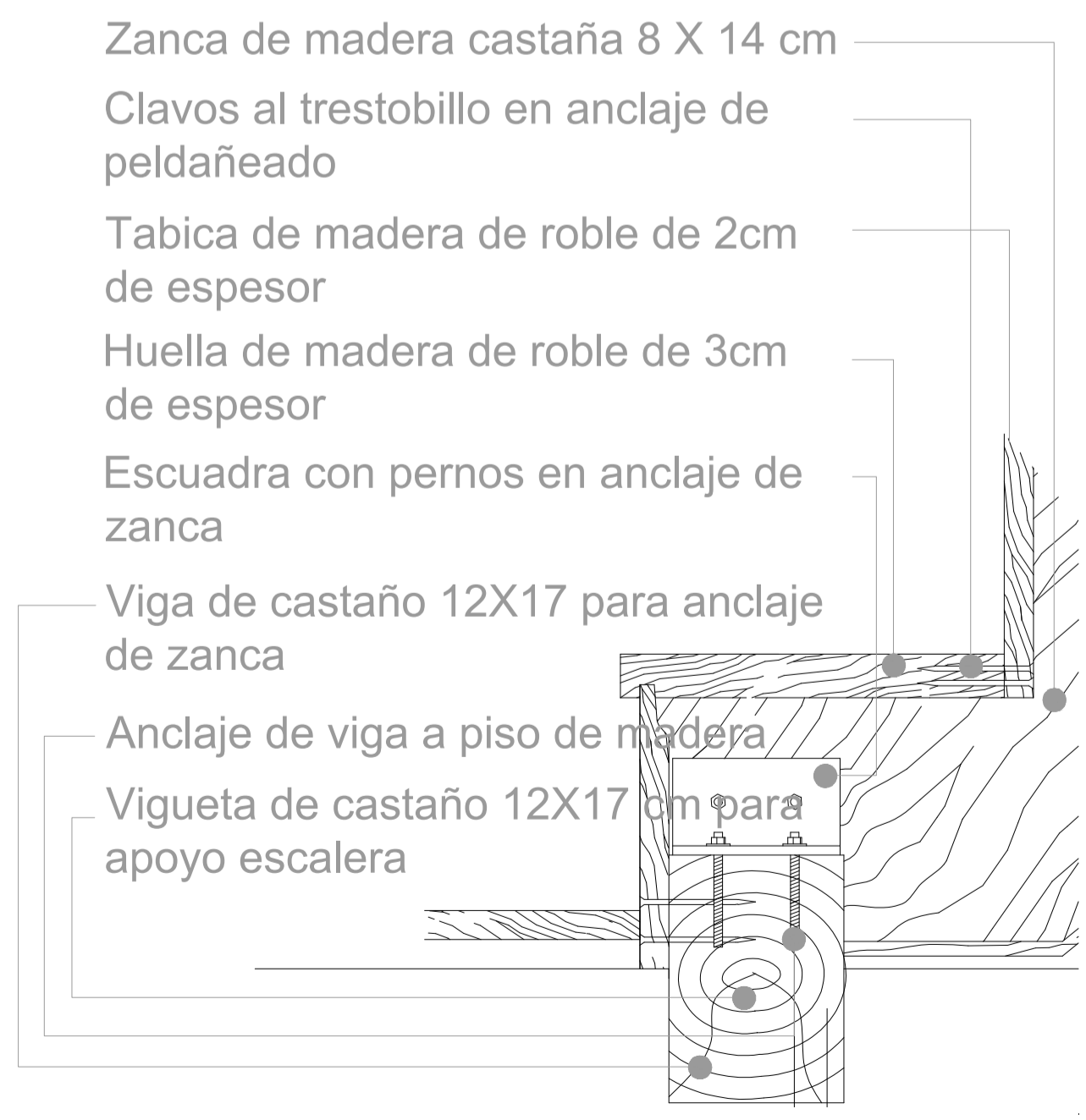
D Detalle anclaje escaleras de madera Esc 1:5
