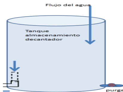
Ilustración 8 Tanque de captación de agua
