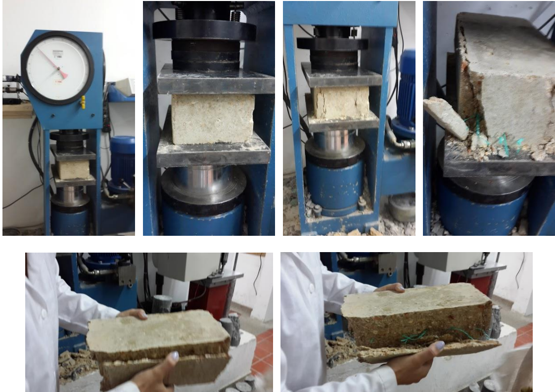
Figura 31. Proceso ensayo prueba a compresión donde se comprime el bloque perdiendo resistencia a sus lados pero con una excelente fuerza en su interior. Fuente: fotografía tomada por autores de la investigación el 16 de mayo 2014.
