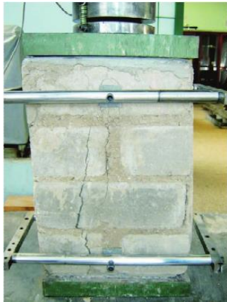
Figura 3. Fotografías de pruebas de bloques de tierra compactada a. prueba a compresión b. ensayo de muretes c. prueba a compresión diagonal. Adaptado de revista Fac. Ing. UPTC, Julio Diciembre 2011. Vol. 20. N o . 31.
