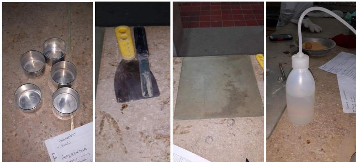
Figura 29. Material y equipo necesario para llevar a cabo la prueba del límite líquido como: cazuela casa grande, gramera, tierra, recipientes metálicos, espátula, vidrio esmerilado y agua. Fuente: fotografía tomada por autores de la investigación 28 de abril 2014.
