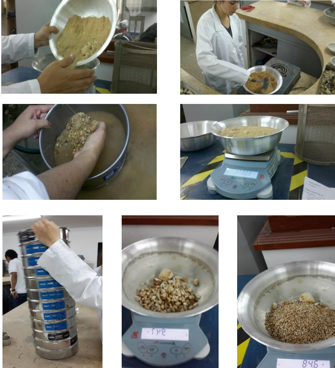
Figura 26. Procedimiento de la prueba de granulometría donde se realiza tamizado del material tomando su peso inicial y peso final, Fuente: fotografía tomada por autores de la investigación 28 de abril 2014.
