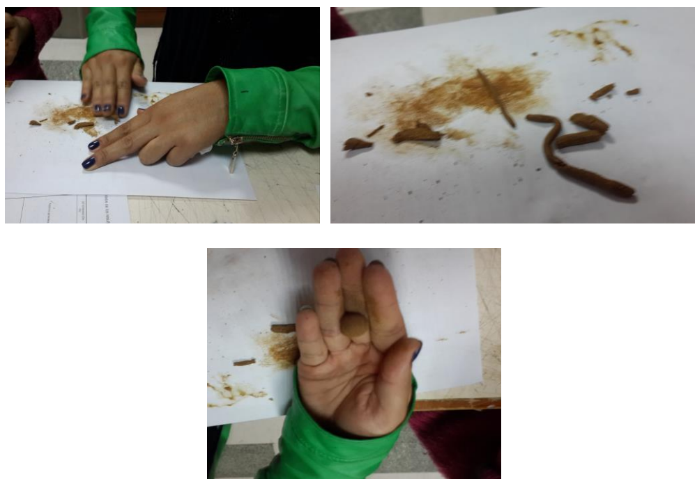
Figura 23. La prueba del cordón muestra que el material es apto para la construcción.
