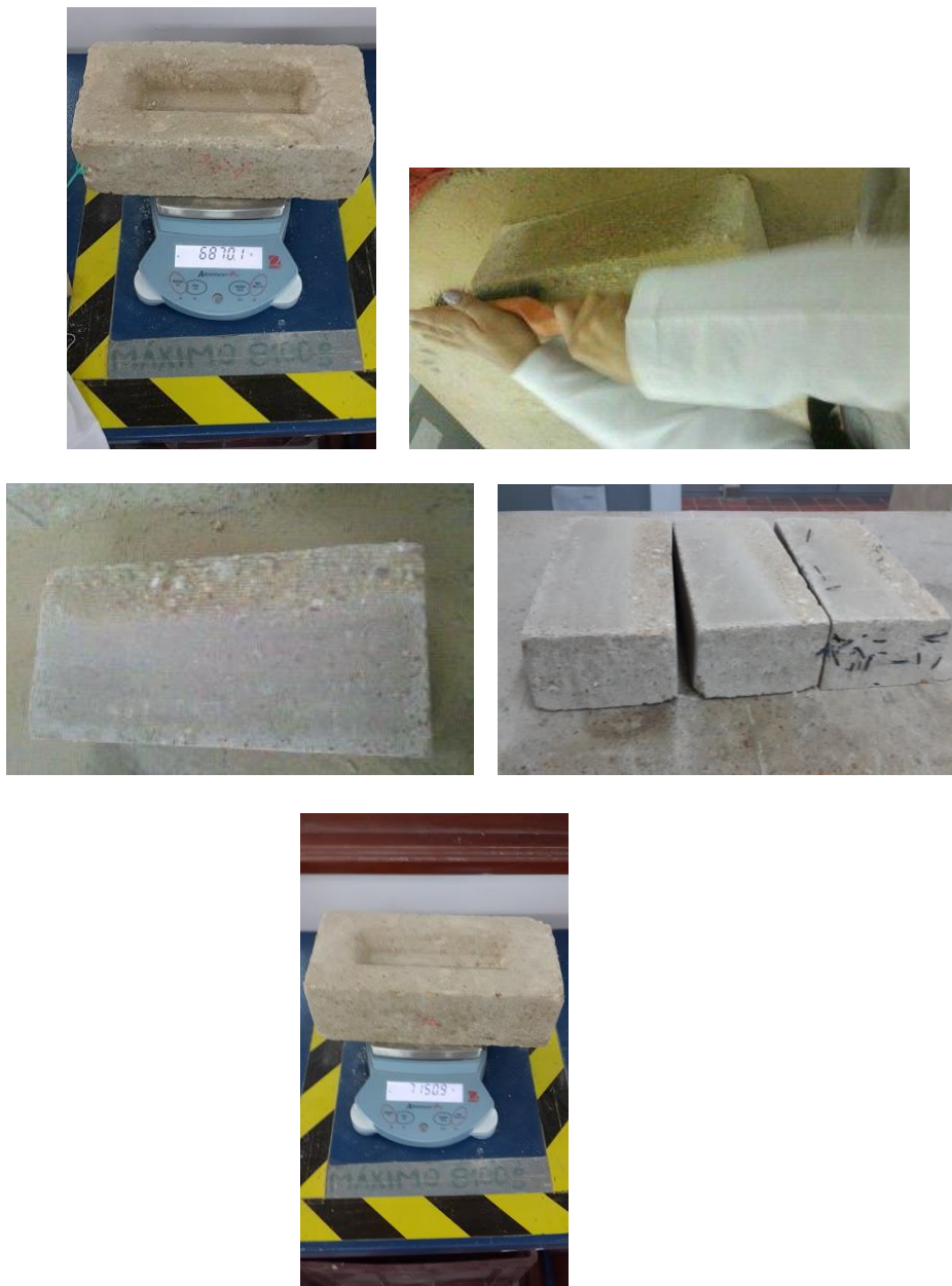
Figura 34. Proceso ensayo prueba de abrasión donde se determina la resistencia del bloque frente al desgaste de erosión de la lluvia y otros agentes del ambiente. Fuente: fotografía tomada por autores de la investigación el 16 de mayo 2014.
