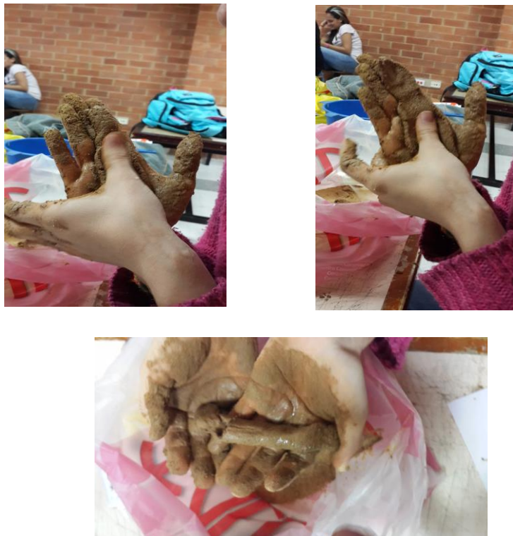
Figura 24. La prueba la cintilla tiene poca arcilla por lo cual es recomendable para la construcción. Fuente: fotografía tomada autores de la investigación 15 de marzo 2014.
