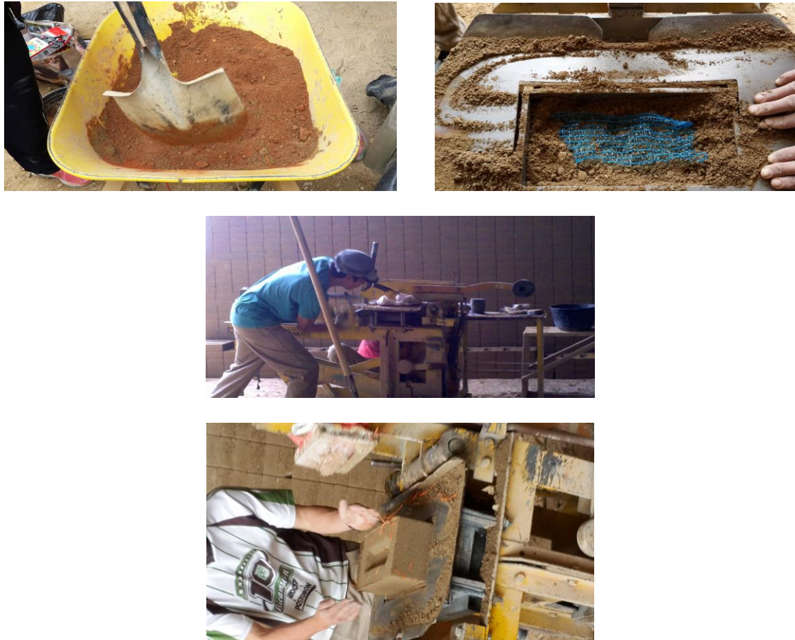
Figura 7. Proceso de producción del BTC desde su prensado hasta su desmolde. Fuente: Fotografía tomada por autores de la investigación 15 de marzo 2014
