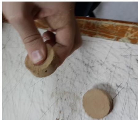
Figura 21. Se oprimieron las pastillas para saber que facilidad tienen para desintegrarse.
