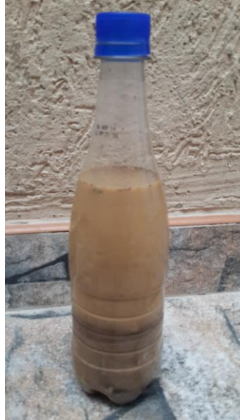
Figura 18. Resultado prueba de sedimentación donde el material muestra solo una capa de tierra. Fuente: fotografía tomada por autores de la investigación 15 de marzo 2014
