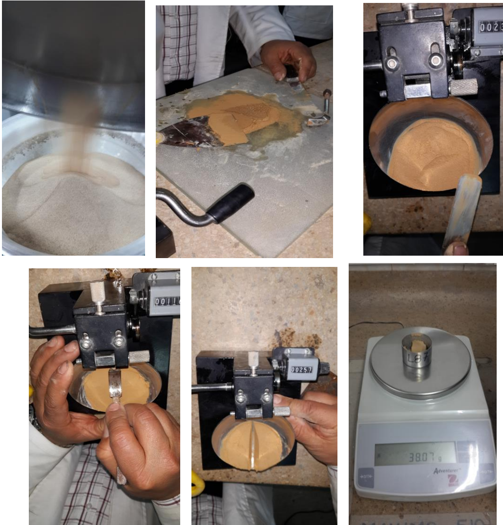
Figura 30. Proceso ensayo prueba del límite líquido donde se ranura el material para determinar la resistencia del corte al suelo. Fuente: fotografía tomada por autores de la investigación el 28 de abril 2014.
