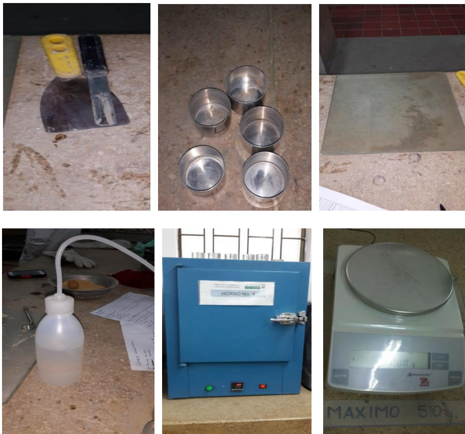
Figura 27. Material y equipo para la prueba del límite plástico como espátulas, recipientes metálicos, vidrio esmerilado, agua, horno y balanza. Fuente: fotografía tomada por autores de la investigación 28 de abril 2014
