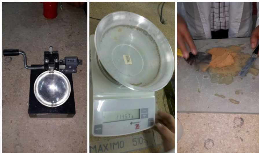
Figura 29. Material y equipo requerido para la prueba del límite líquido
