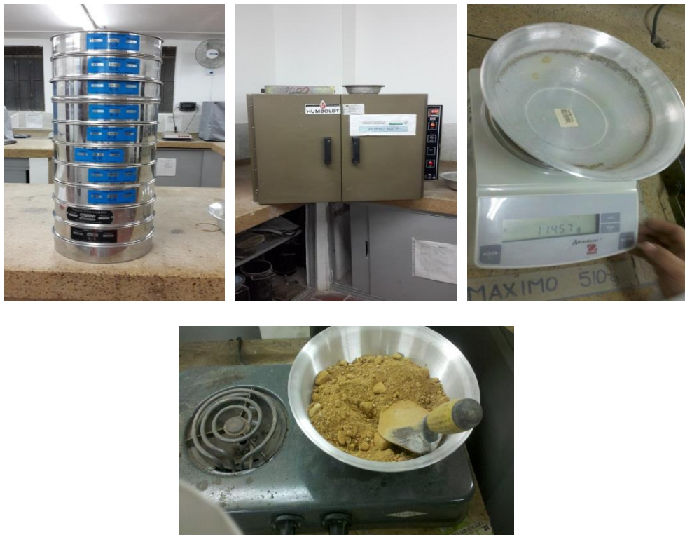
Figura 25. Materiales y equipo requerido para granulometría como: pasa tamiz, horno, balanza, estufa y tierra. Fuente: fotografía tomada por autores de la investigación 28 de abril 2014.
