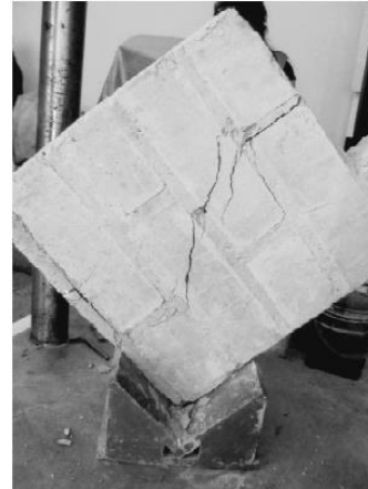
Figura 3. Fotografías de pruebas de bloques de tierra compactada a. prueba a compresión b. ensayo de muretes c. prueba a compresión diagonal. Adaptado de revista Fac. Ing. UPTC, Julio Diciembre 2011. Vol. 20. N o . 31.
