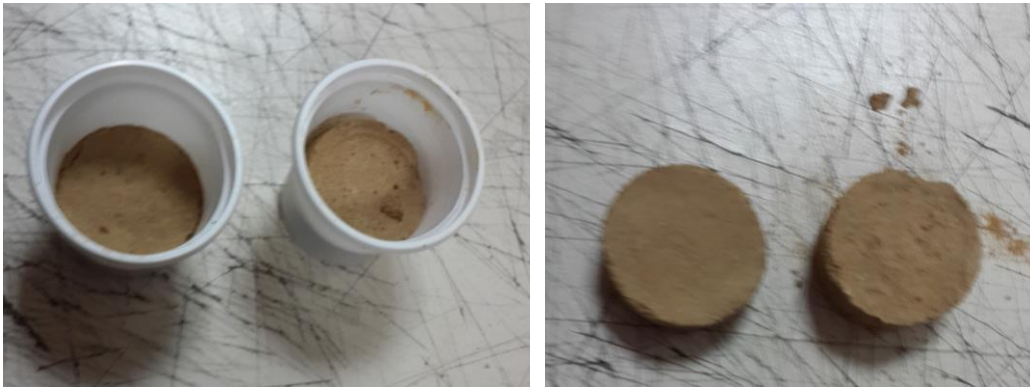
Figura 20. Fabricación de las pastillas de tierra necesarias para la prueba de resistencia en seco Fuente: fotografía tomada por autores de la investigación 15 de marzo 2014
