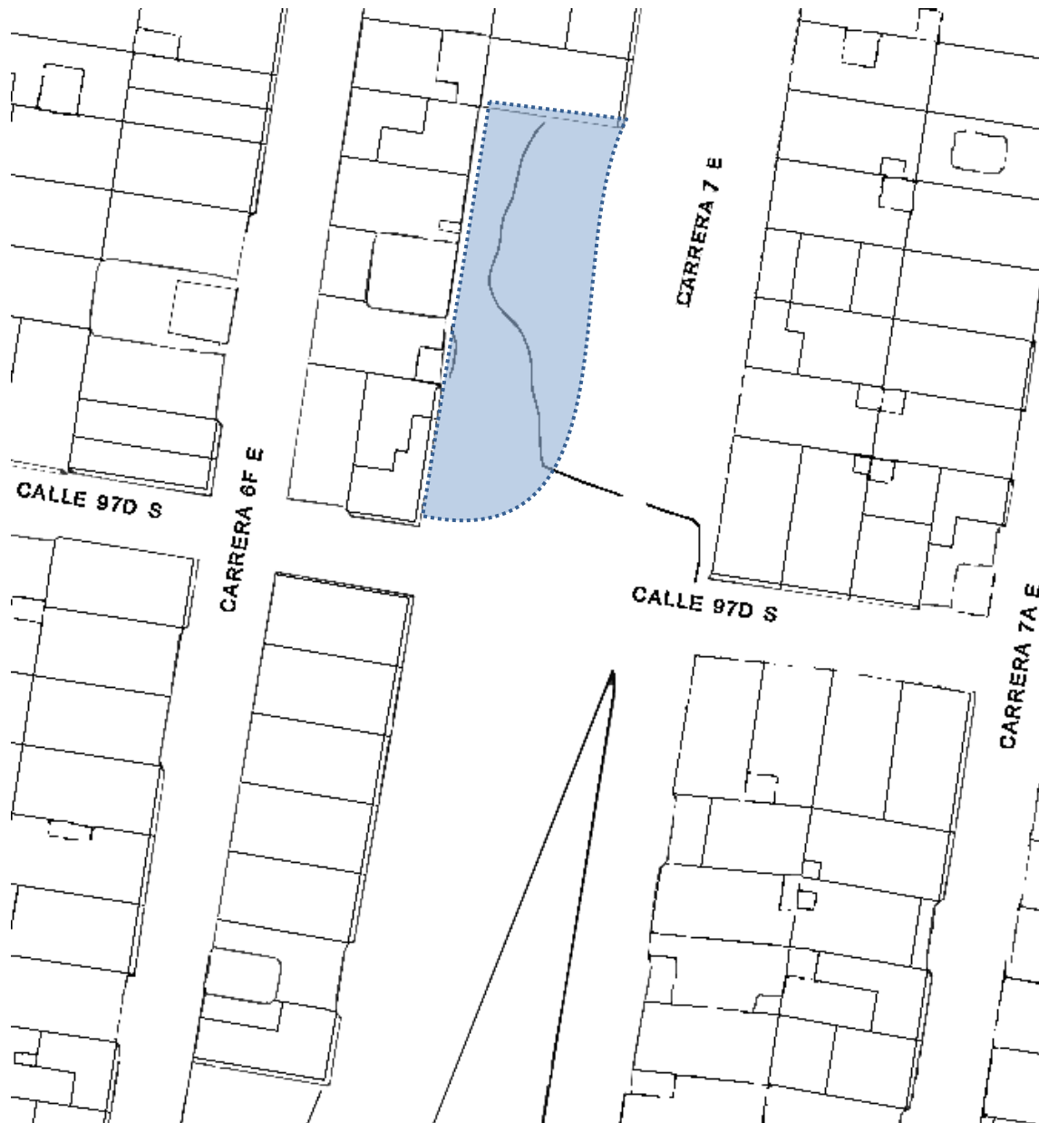
Figura 23. Plano de lote Villa Hermosa con curvas de Nivel. El terreno en el que se va a construir el salón comunal posee características topográficas que permiten diseñar el objeto arquitectónico sin restricción alguna Elaboración Propia.
