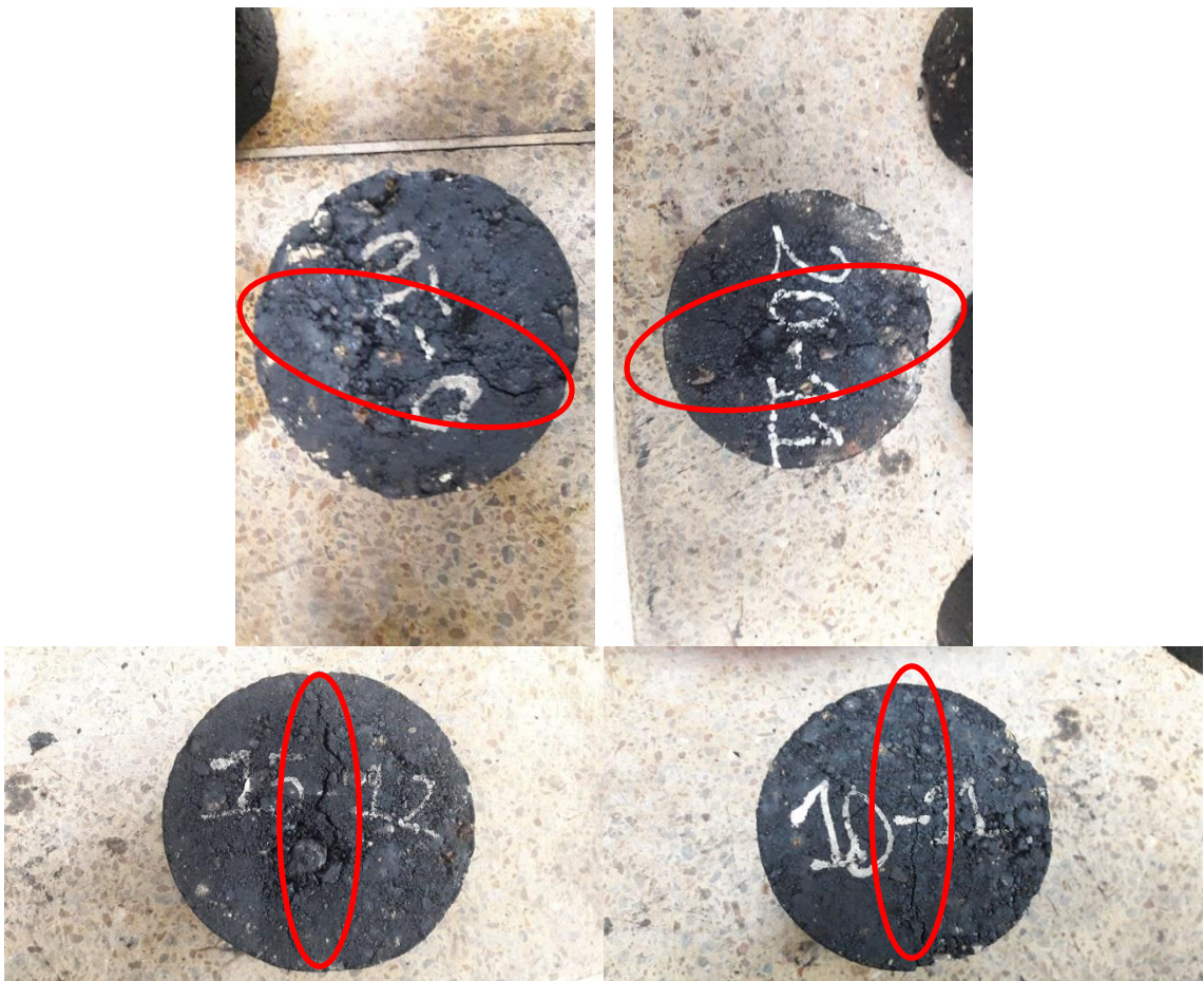
Figura 23 Evaluación visual del daño por humedad
