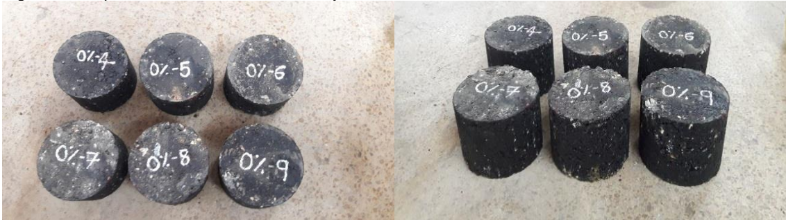
Figura 11 Briquetas 0% GCR – Gravedades y vacíos
