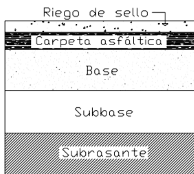
Figura 1 Capas del pavimento
