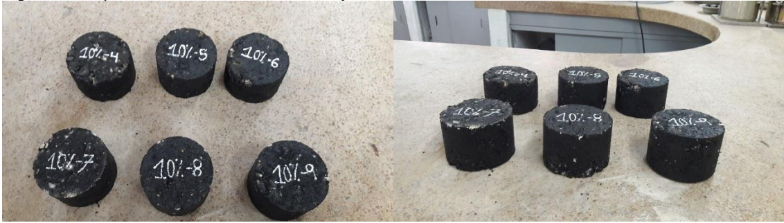
Figura 14 Briquetas 10% GCR – Gravedades y vacíos
