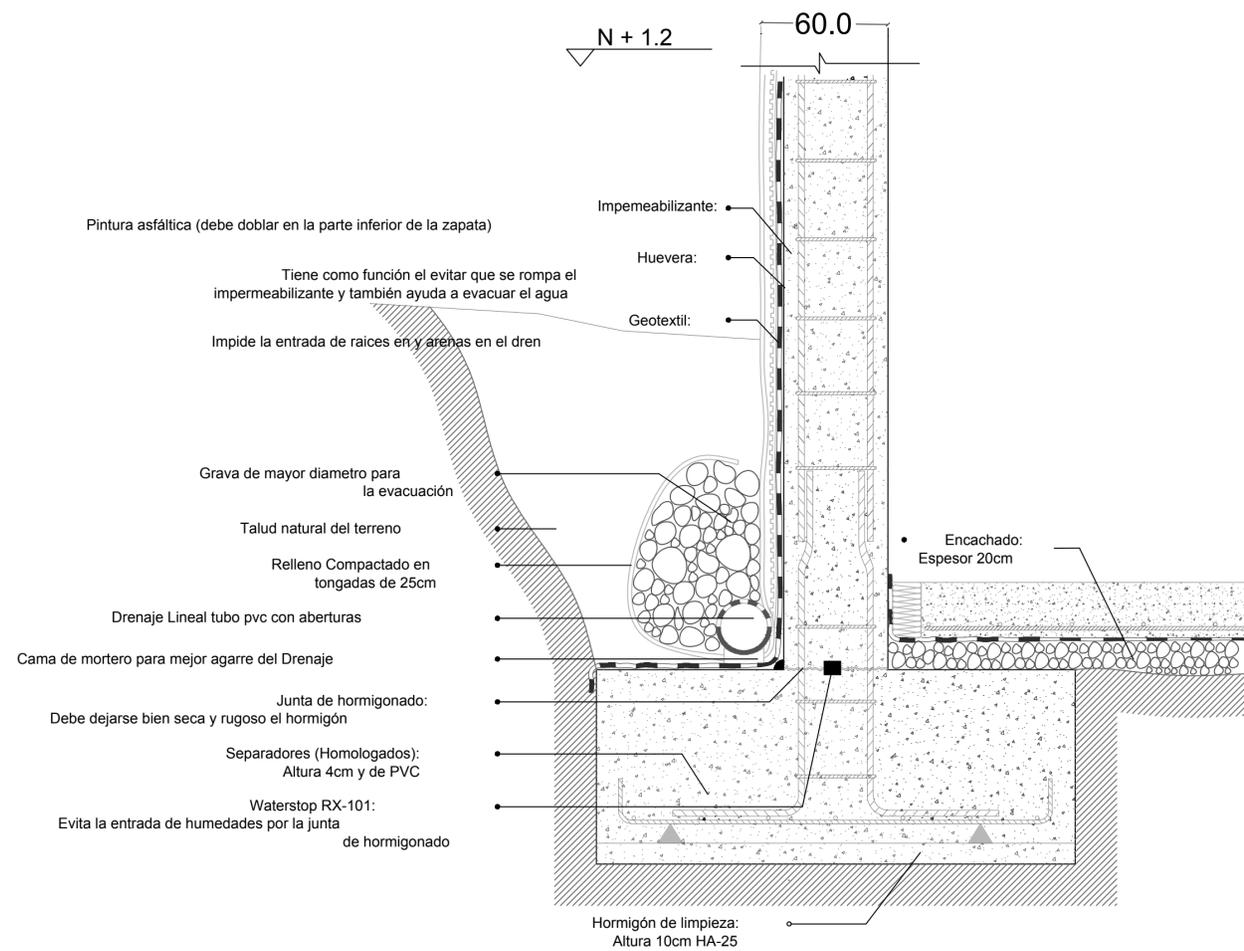
**A** Detalle muro de contención
