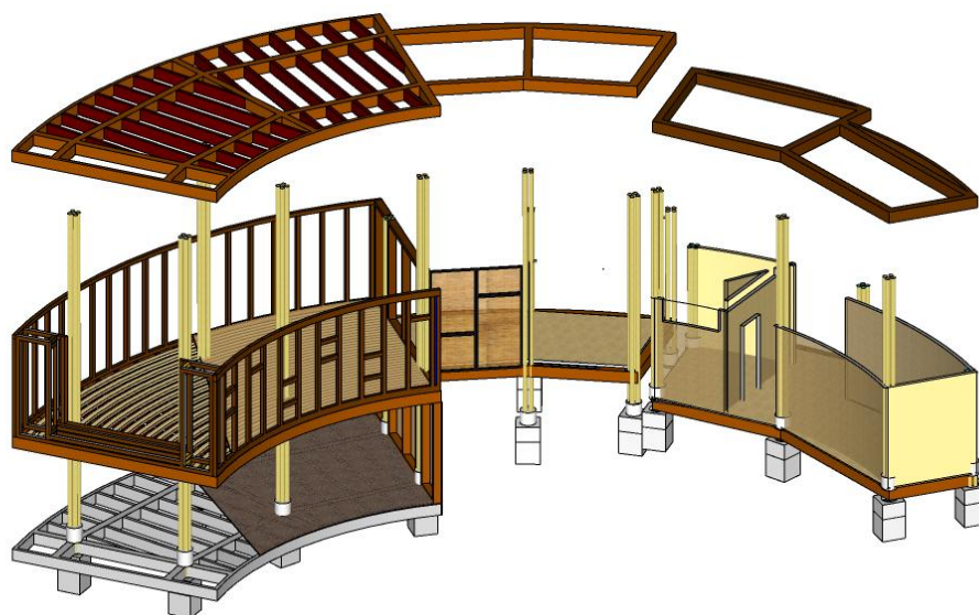
Figura 60: conformación de losas de contrapiso y entepiso del bloque multipropósito. Fuente: Elaboración propia
