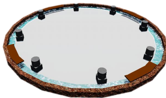
Figura 61: Cimentación del bloque del bohío. Fuente: Elaboración propia.
