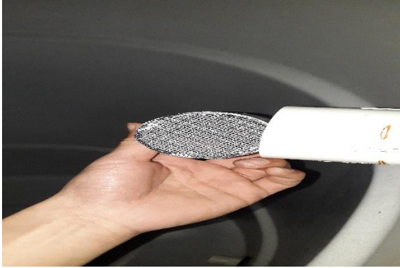
Figura 27: Filtro en el interior del tanque.
