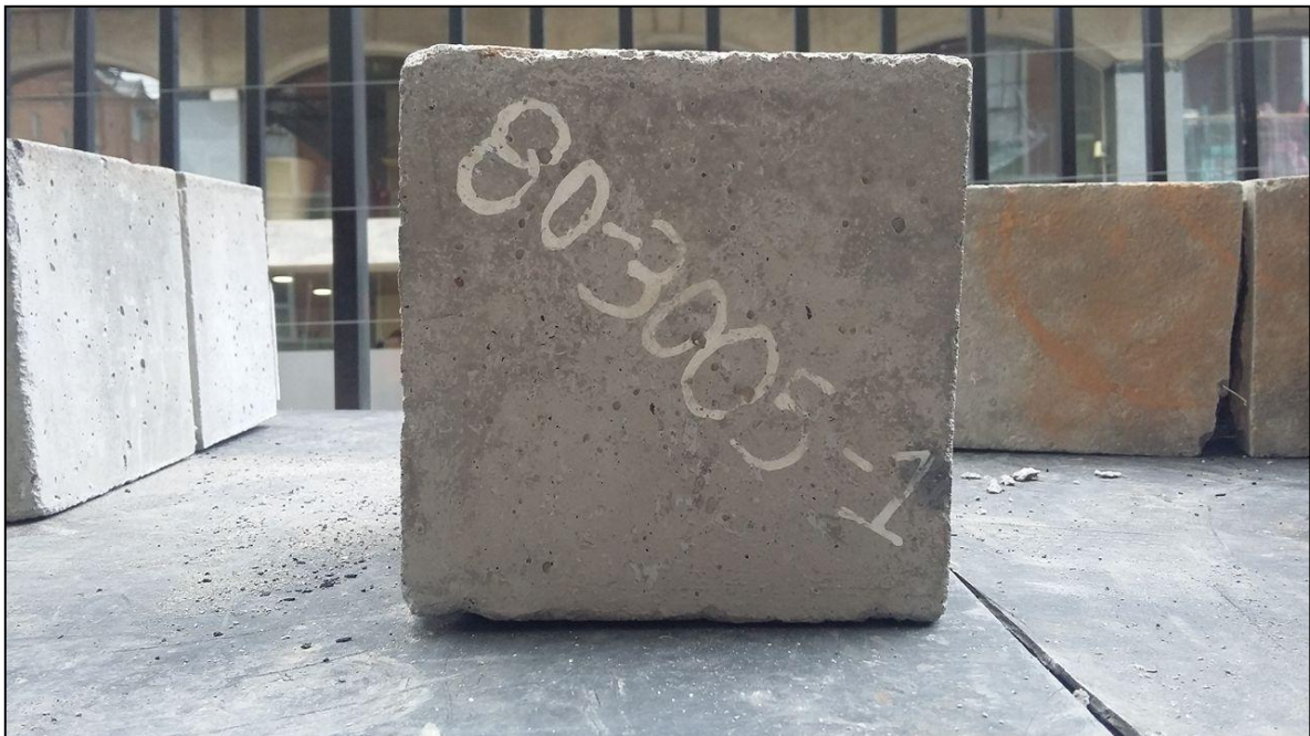
Imagen 60. Sección Deformada Vigueta 80-3005-1
