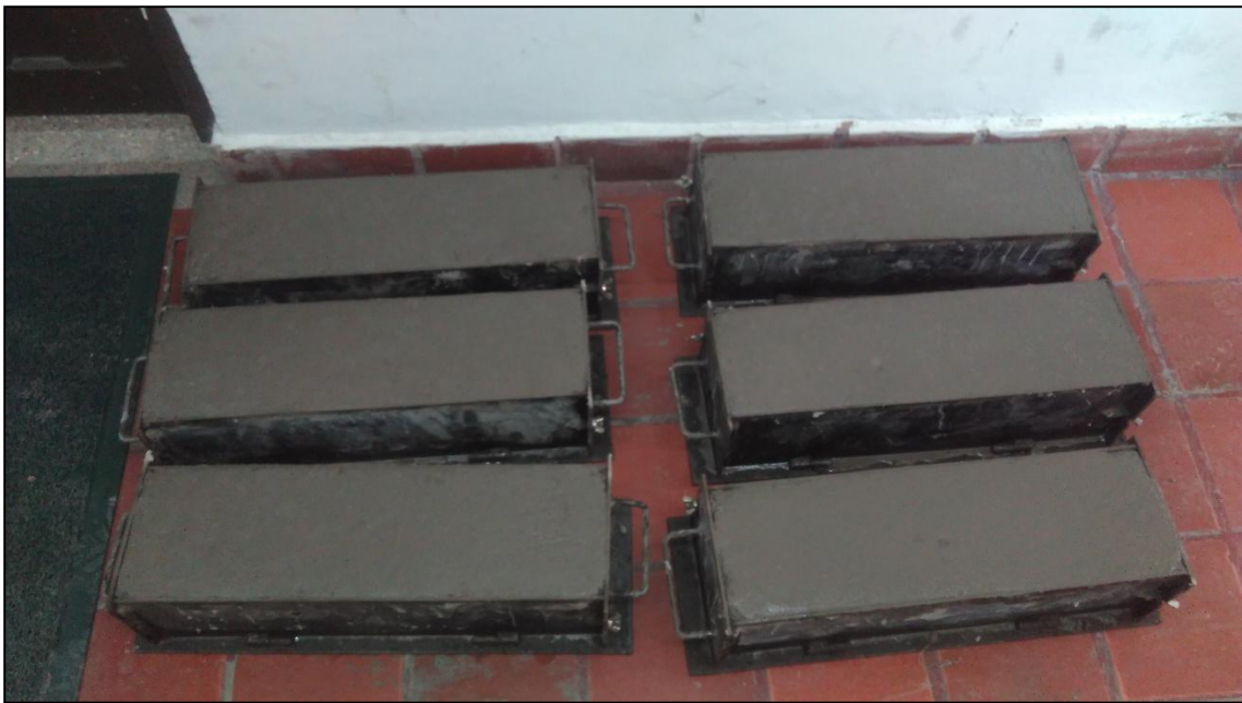
Imagen 50. Mezclas ya Vertidas en las Formaleta.
