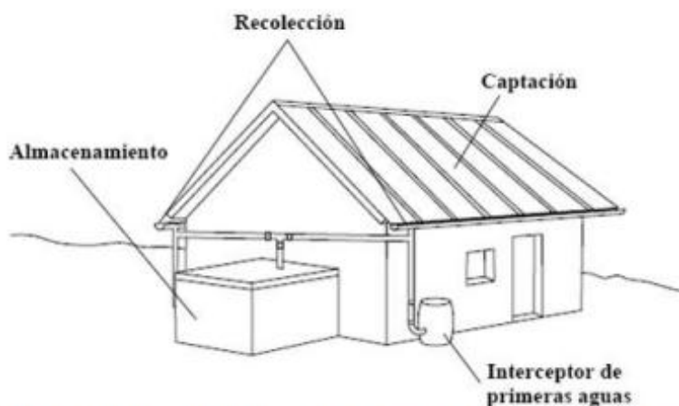
Figura 8 Sistema típico de captación de agua lluvia en techos
