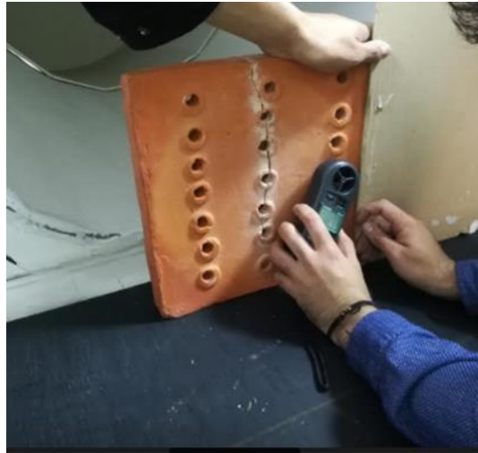
Ilustración 30 Primer ensayo de túnel de viento, la tableta no contenía tela ni hidrogeles
