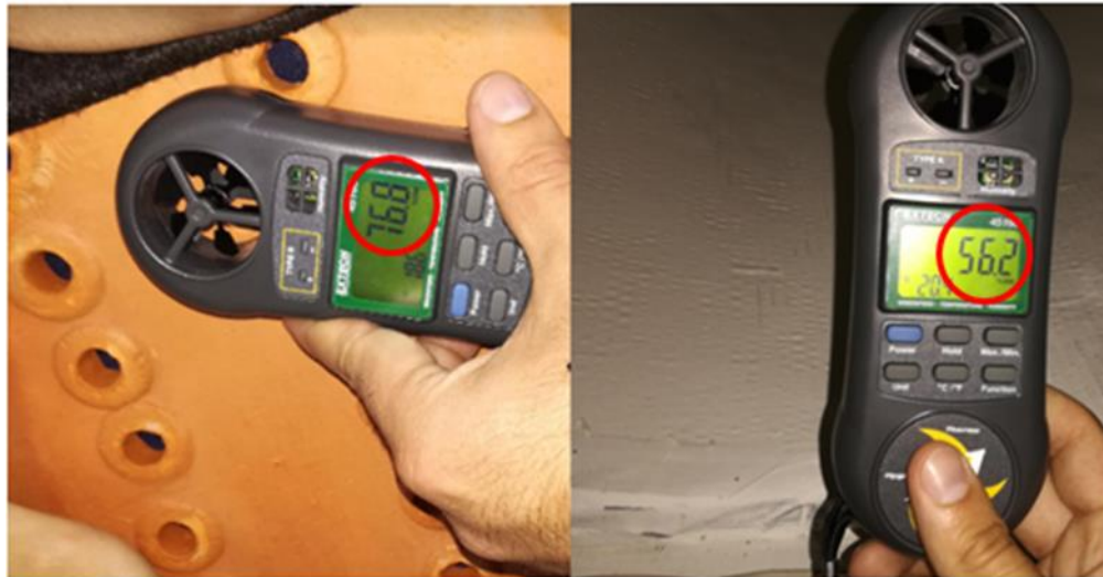
Porcentaje de humedad y temperatura durante la prueba.
