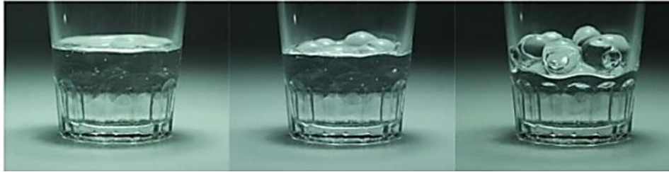
Ilustración 7 Absorción de agua por el hidrogel en aproximadamente en 2.5 horas.
