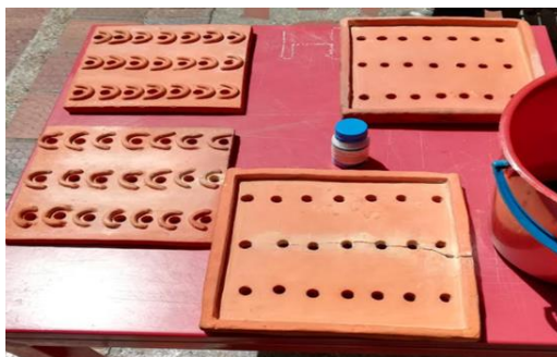
Ilustración 26 Colocación de las tabletas al sol
