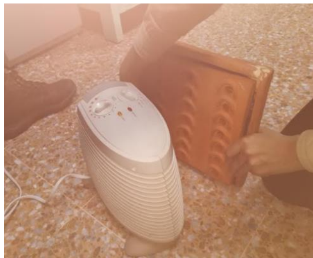
Ilustración 33 Paso del aire caliente en el prototipo con un calefactor
