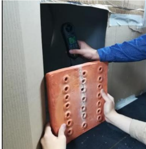
Ilustración 31 Segunda medición del paso del viento por los orificios de la tableta
