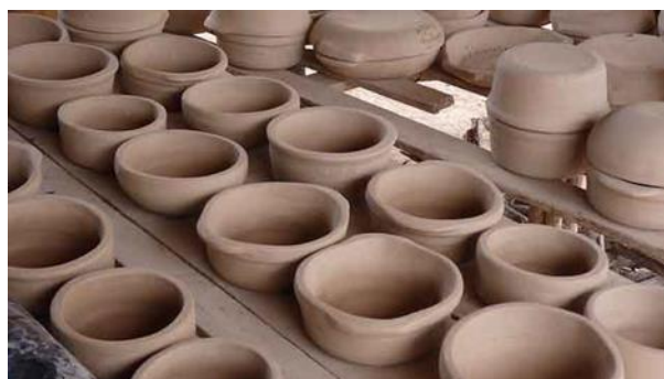
Ilustración 9 Secado de piezas de Arcilla
