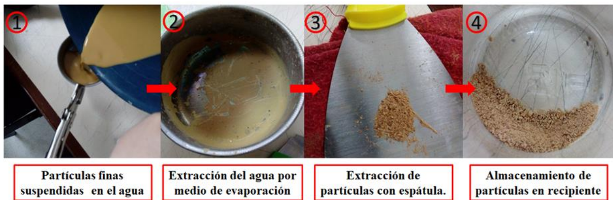
Figura 24. Separación granulométrica - levigación - extracción de líquido.
