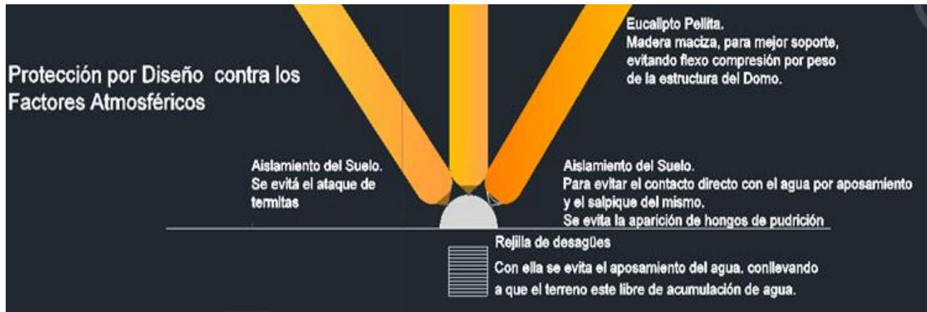
[Figura 21.Plano detalle protección contra humedad y ataque de termitas, Domo Kiddies Parque Mundo Aventura, especificación del detalle.](#)
