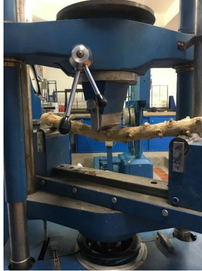
Figura 31. Prueba de flexión tercera probeta (Fuente, Elaboración propia)
