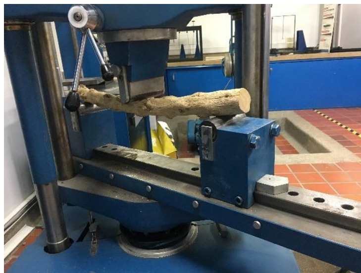
Figura 28. Ubicación de la probeta e inicio de ensayo (Fuente, Elaboración propia)
