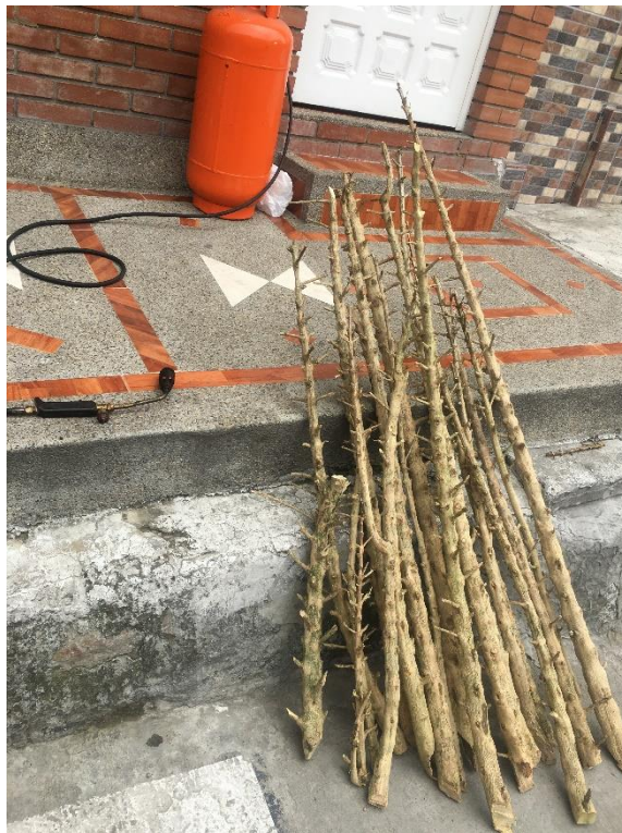
Figura 17. Secado de la C.A con soplete (Fuente, Elaboración propia)
