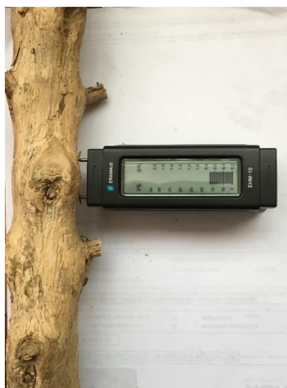
Figura 24. Probeta con porcentaje de humedad bajo (Fuente, Elaboración propia)
