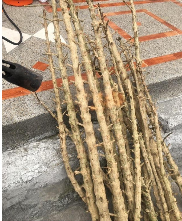
Figura 18. Secado de la C.A con soplete (Fuente, Elaboración propia)
