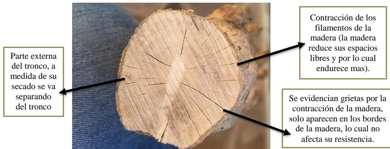
Figura 41 Madera muestra contracción de sus filamentos (Fuente, Elaboración propia)
