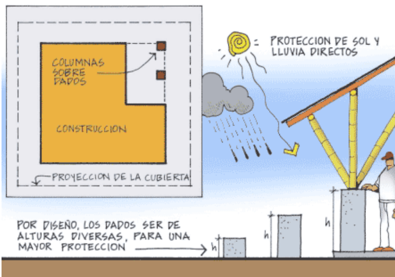
FIGURA 40: PROTECCIÓN PARA LA GUADUA, DEPENDE LA AULTURA DE LOS DADOS DE CIMENTACIÓN
