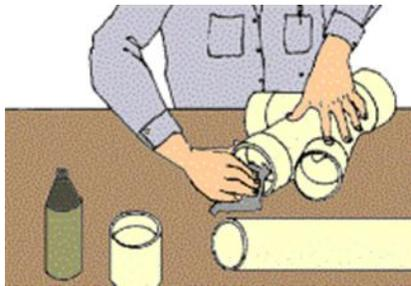
PASO 6: Aplicar soldadura en tubo - se aplica la soldadura con una brocha en el extremo del tubo en un ancho igual al de la campana del accesorio.
