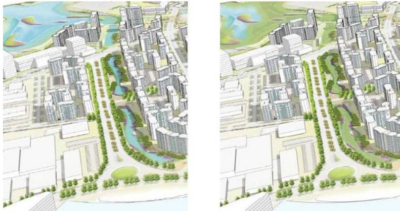
Se viene diseñando en el proyecto Maiporé al sur de Bogotá donde se utiliza la Bio-retención que no es otra cosa que la administración y tratamiento de las escorrentías de aguas pluviales a través de depresiones poco profundas, utilizando una base de materiales que permiten la infiltración y plantas, para reducir la escorrentía y tratar las aguas en sitio.
