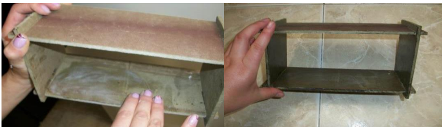
Imagen 11 Proceso de aplicación de sustancia desmoldante (vaselina)
