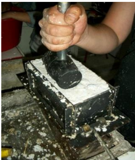
Imagen 18 Proceso de vaciado de la mezcla en el molde metálico
