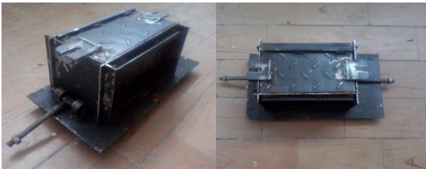
Imagen 16 Molde metálico para elaboración del ladrillo ecológico
