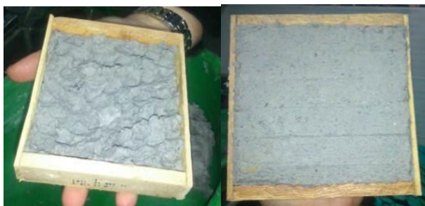
Imagen 9 Proceso de vaciado de la mezcla dentro del molde
