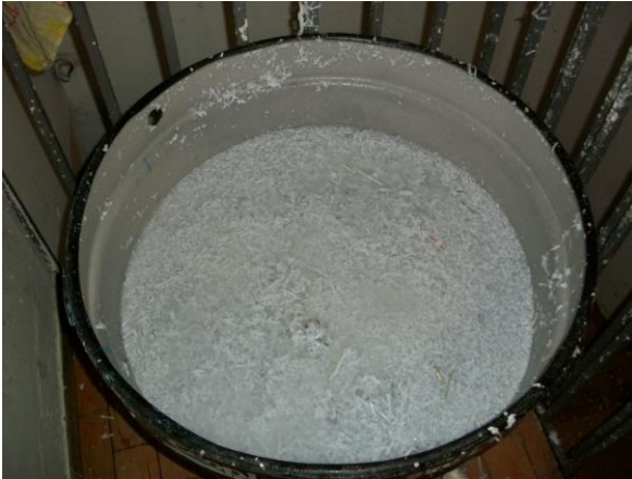
Imagen 15 Proceso de triturado mecánico del papel de archivo
