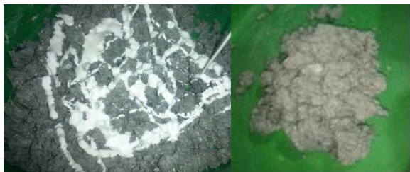
Imagen 8 Proceso de mezcla del papel el yeso y el PVA
