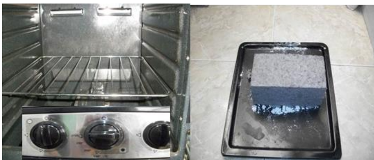
Secado en horno a gas a temperatura de 250°C
