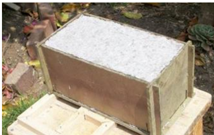
Imagen 12 Proceso de vaciado de la mezcla con papel periódico
