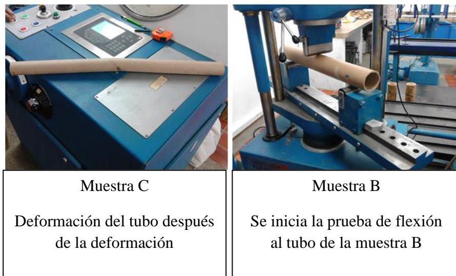
IMAGEN 13. Pruebas de flexión muestra B y C
