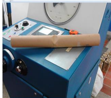
IMAGEN 14. Pruebas de flexión muestra A y B
