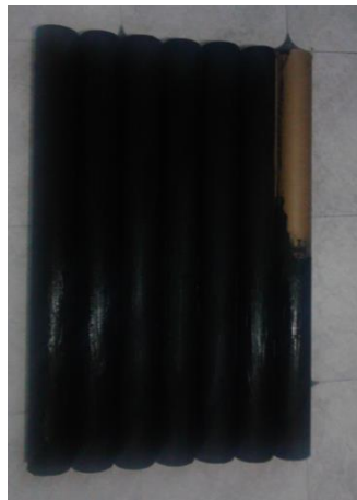
IMAGEN 29. Aplicación de la emulsión asfáltica en los tubos de cartón
