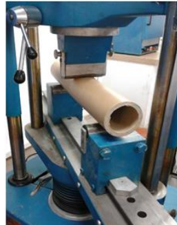
IMAGEN 14. Pruebas de flexión muestra A y B
