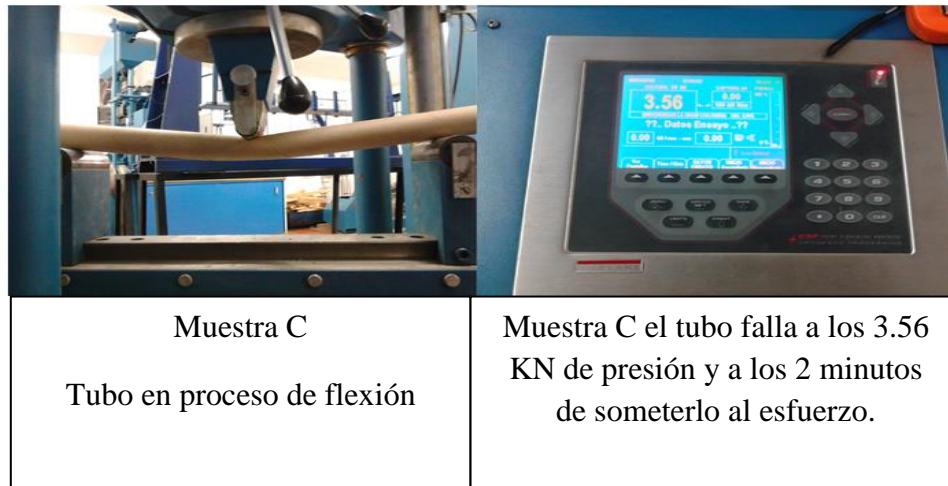
IMAGEN 12. Prueba de flexión muestra C
