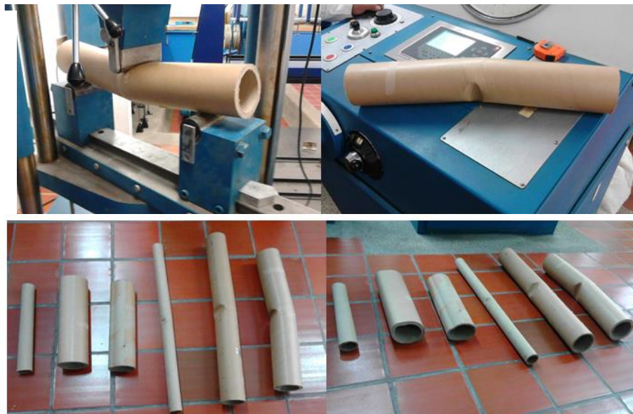
IMAGEN 15. Resultado de la deformación en aplastamiento y flexión
