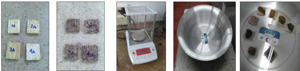
Figura 13: procedimiento realización prueba absorción de agua según ASTM D 1037
