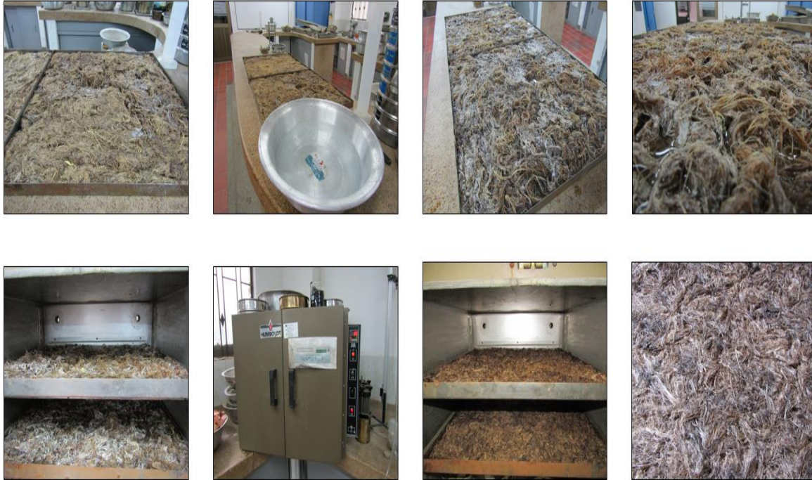
Figura 32: último proceso de elaboración última capa absorbente acústica de la caja reverberante.
