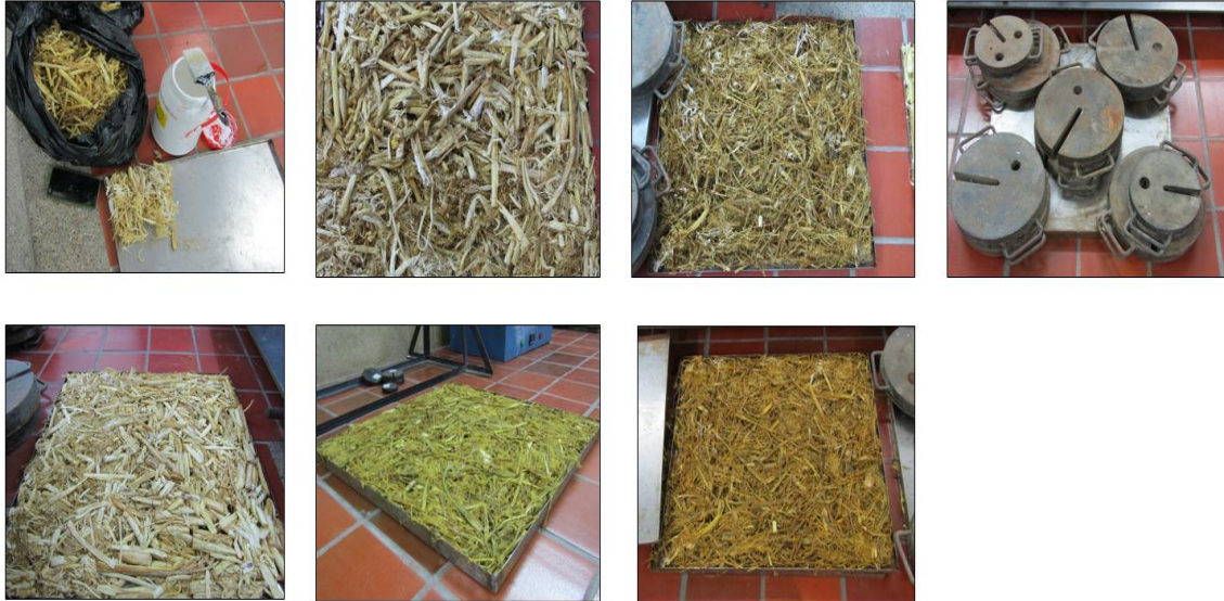
Figura 33 : proceso de elaboración tres capas faltantes absorbentes acústicas de la caja reverberante.
