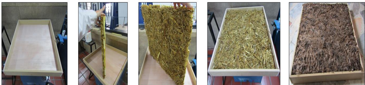
Figura 34 : Proceso de armado caja reverberante de 6 cm.
