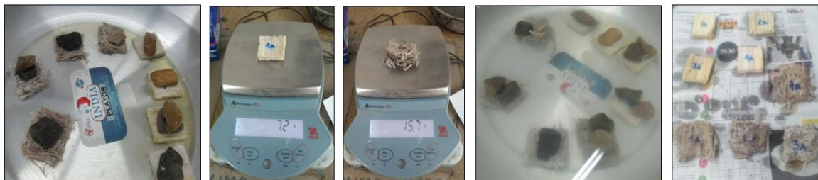
Figura 14: Procedimiento para desarrollo prueba absorción de agua según ASTM D 1037
