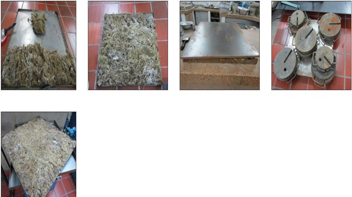
Figura 31: primer proceso de elaboración última capa absorbente acústica de la caja reverberante.
