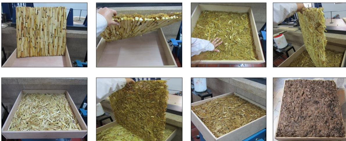
Figura 35: Proceso de armado caja reverberante de 11 cm.
