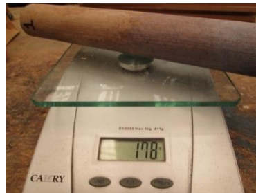
Tubo 1. Impermeabilizante paraguas. Peso inicial 110g, peso final 116g, diferencia 6g.
