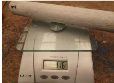
Tubo 1. Imprimpante acrílico greconal. Peso inicial 113g, peso final 178g, difencia 65g.
