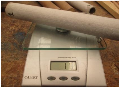
Tubo 1. Imprimpante acrílico greconal. Peso inicial 113g, peso final 178g, difencia 65g.
