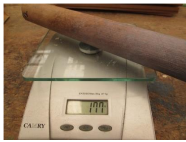
Tubo 2. Imprimpante acrílico Greconal. Peso inicial 109g, peso final 177g, diferencia 66g.
