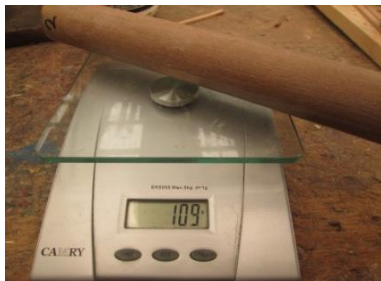
Tubo 2. Imprimpante acrílico Greconal. Peso inicial 109g, peso final 177g, diferencia 66g.
