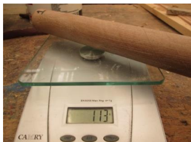
Tubo 1. Impermeabilizante paraguas. Peso inicial 110g, peso final 116g, diferencia 6g.
