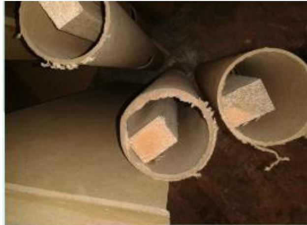
Figura 7 Reforzamiento en el tubo de cartón
