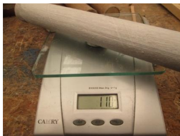
Tubo 2. Impermeabilizante paraguas. Peso inicial 110g, peso final 168g, diferencia 58g.
