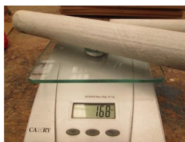
Tubo 2. Impermeabilizante paraguas. Peso inicial 110g, peso final 168g, diferencia 58g.
