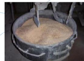
\*Reemplazo de la arena por aserrín para la fabricación de concreto
