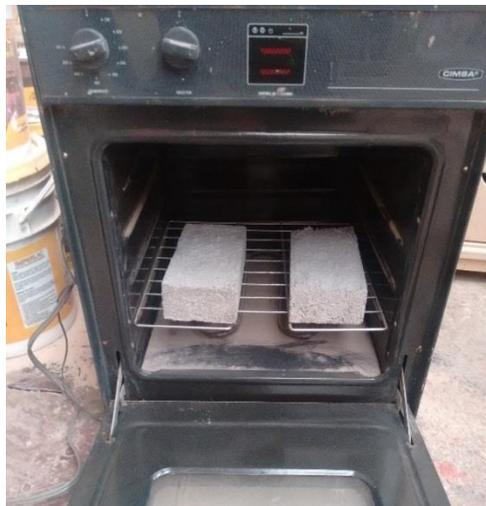
Ilustración 11. El horno fue usado para la aceleración del secado del mampuesto. Fuente: Elaboración propia (2016)
