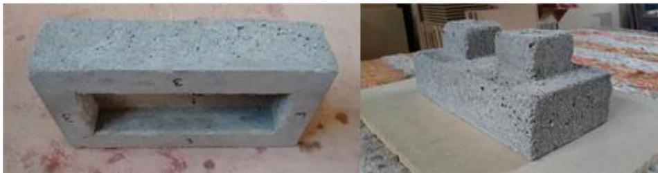
Ilustración 15: Ladrillo tipo lego cuadrado realizado con plástico triturado, arena y cemento. Fuente: Elaboración propia (2016)
