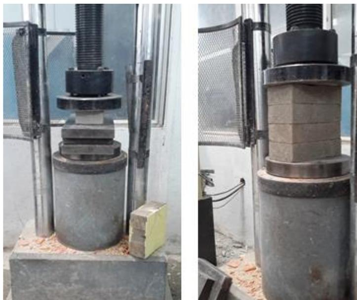
Ilustración 18: En la izquierda se muestra el fallo a un ladrillo y en la derecha el fallo a un murete ladriplast.
