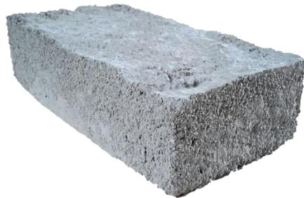
Ilustración 10. Ladrillo macizo realizado con plástico triturado y cemento. Fuente: Elaboración ropa (2016)
