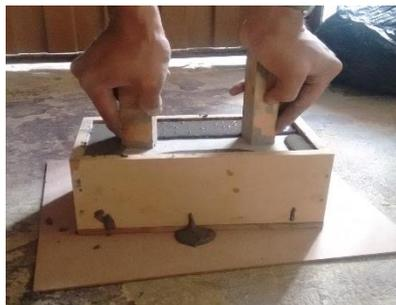
Ilustración 13: Muestra el proceso de compactación realizado manualmente Fuente: Elaboración propia (2016)
