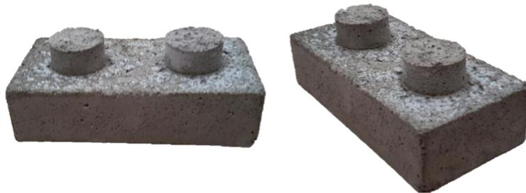
Ilustración 8. Ladrillos ladriplast tipo lego. Fuente: Elaboración propia (2016)
