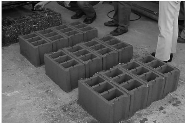
Ilustración 6. Tipo de ladrillo realizado en esta investigación Fuente: Revista Invi Recuperado de: <http://www.arpet.org/docs/Ladrillos-y-placas-prefabricadas-con-plasticos-reciclados-Gaggino.pdf>
