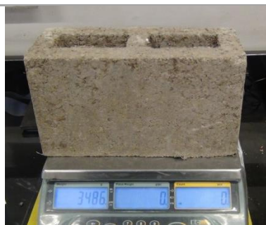
Ilustración 13: Mampuestos con perforación vertical- Dosificación tipo 3
