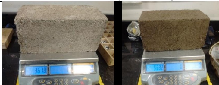
Ilustración 21: Prueba de adsorción de agua dosificación tipo 1
