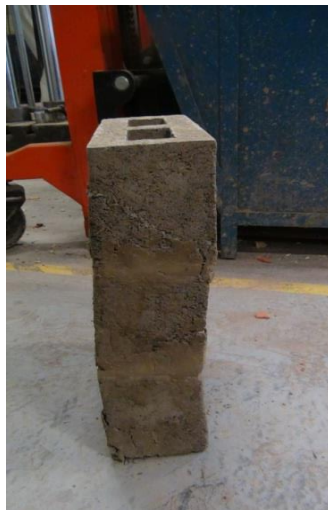
Ilustración 18: Deformación del murete
