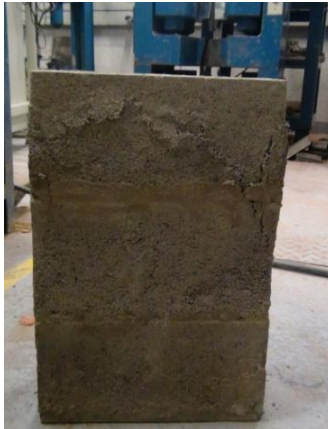
Ilustración 19: Resultado final de la falla del murete
