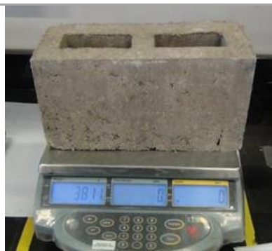
Ilustración 12: Mampuestos con perforación vertical-Dosificación tipo 2
