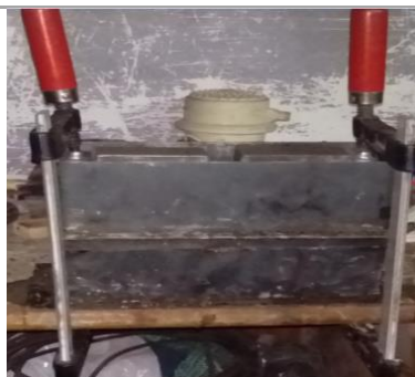
Ilustración 9: Compactación de mezcla con prensa manual
