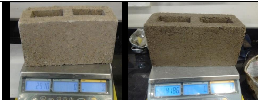
Ilustración 25: Prueba de adsorción de agua dosificación tipo 5
