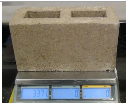
Ilustración 14: Mampuestos con perforación vertical-Dosificación tipo 4
