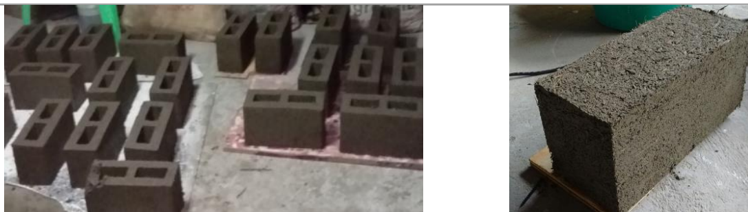
Ilustración 10: Desmoldado y curado del producto
