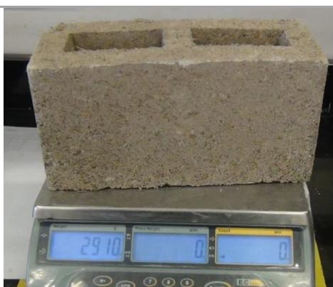
Ilustración 15: Mampuestos con perforación vertical- Dosificación tipo 5
