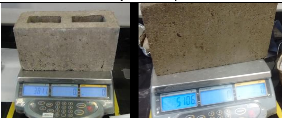
Ilustración 22: Prueba de adsorción de agua dosificación tipo 2
