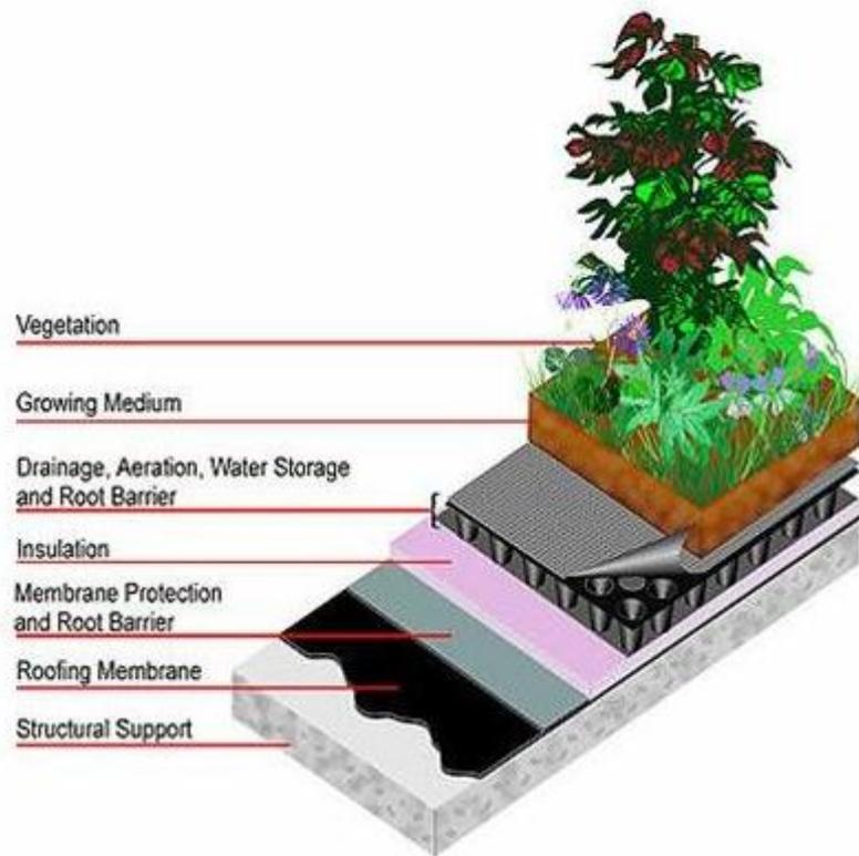
**Figura 4.** Tipo de cubierta intensiva
