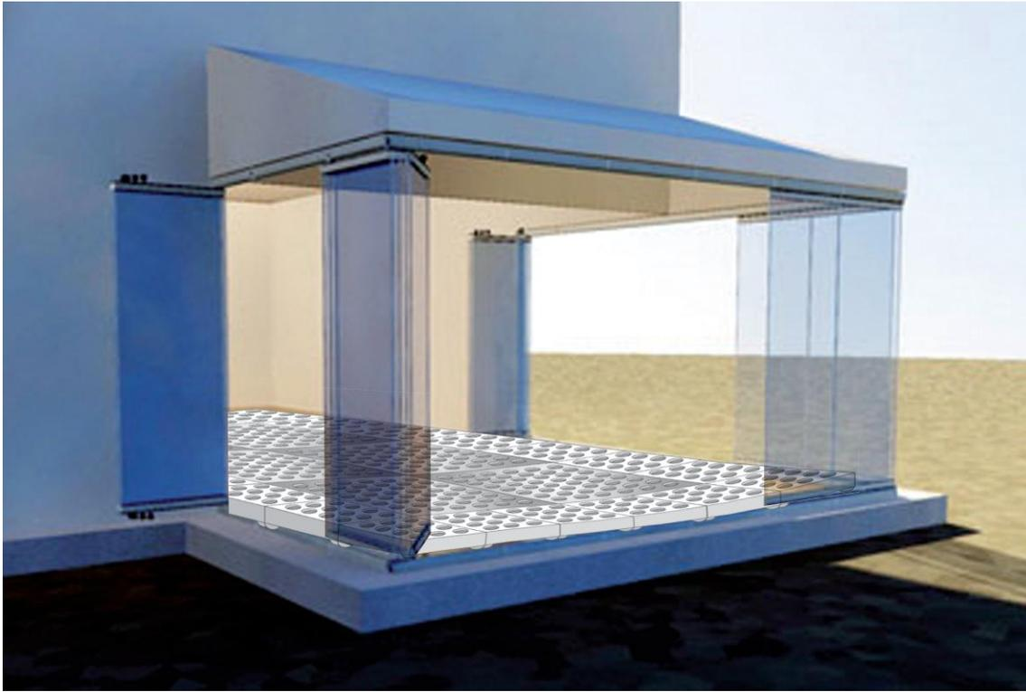
**Figura 17.** Ejemplo de modulación para áreas cuadradas y rectangulares.
