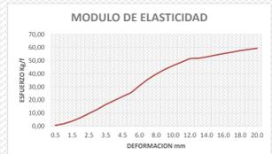
En la prueba de deformación aplicada a los muretes de mampostería en plástico poliestireno se observa una constante de resistencia en la fuerza aplicada en el rango de los 13mm hacia abajo en cuando a la presión ejercida por la máquina.
