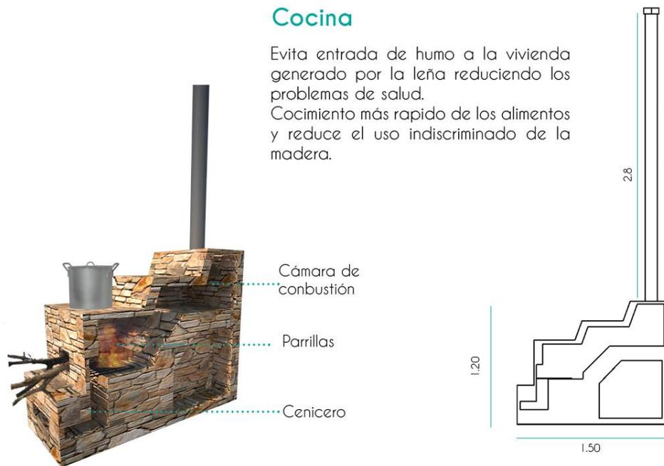
**Figura 61. Prototipo de estufa y cocina. Fuente. German Paipa de 2014**
