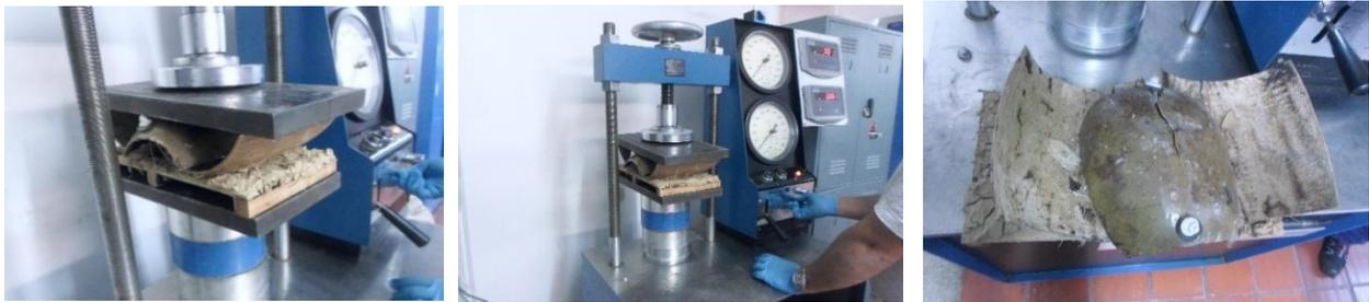
Figura 44. Prueba de resistencia de flexo compresión con todo el sistema y elementos complementarios.
