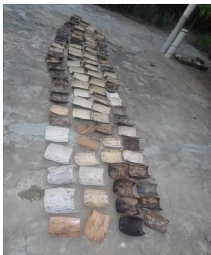
Figura 36. Tejas de totumo secas listas para instalar
