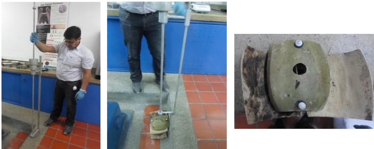
Figura 46. Prueba de impacto con cono dinámico.
