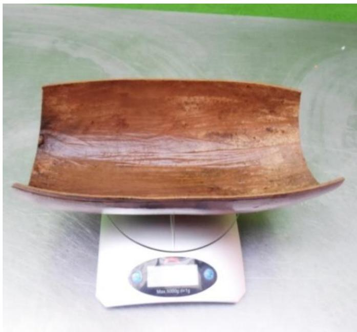
Figura 49. Teja de totumo pesada para determinar su absorción, después de 24 horas sumergida al agua.
