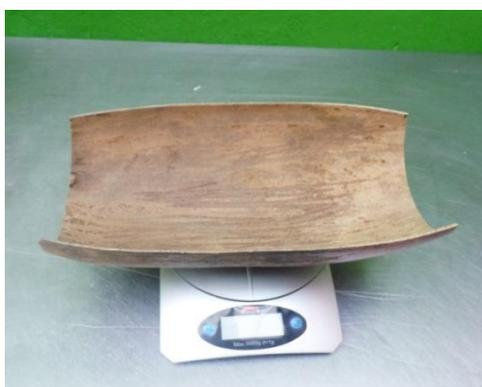
Figura 47. Análisis de peso teja canal para prueba de absorción.
