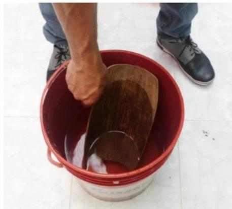
Figura 48. Teja de totumo sumergida en agua, para luego retirar después de 24 horas.
