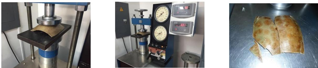
Figura 43. Prueba de resistencia de flexo compresión
