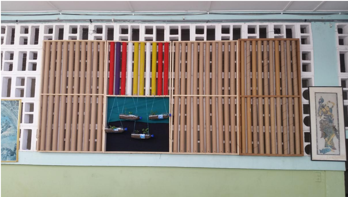
Ilustración 38 prototipo instalado medicion piloto de reducción 15dB : producción propia
