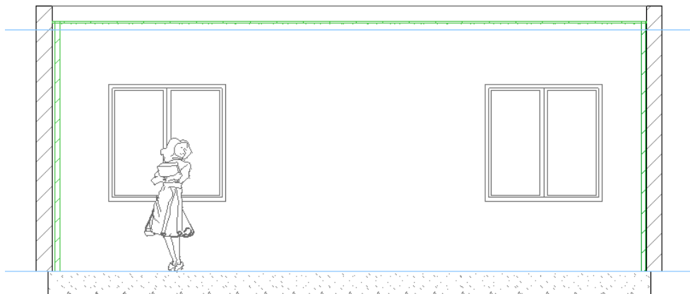
Ilustración 23-1. detalle aislamiento acústico tapa con frescas y lamina de yeso en techo y paredes.
