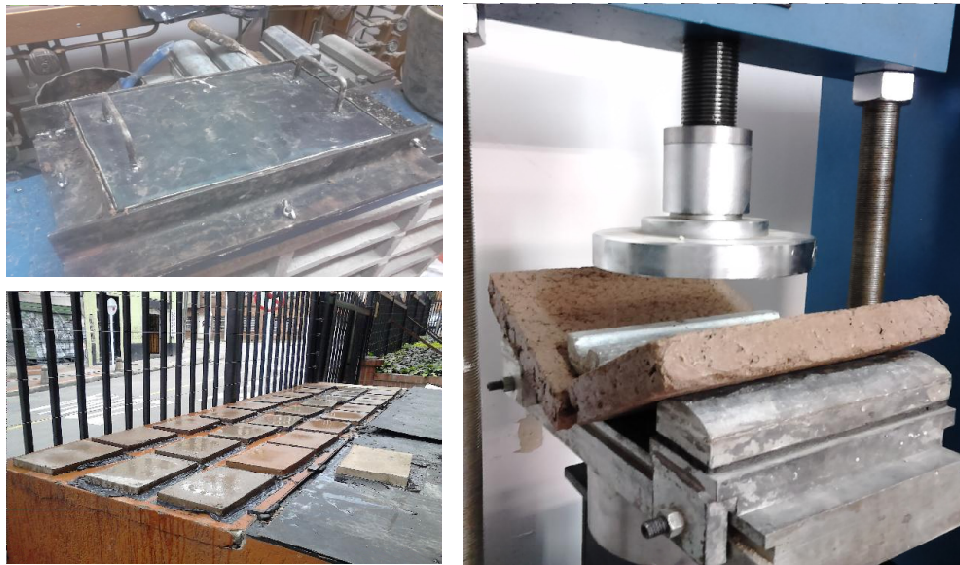
Figura 39 Procedimiento prueba de flexión del material. Autor
