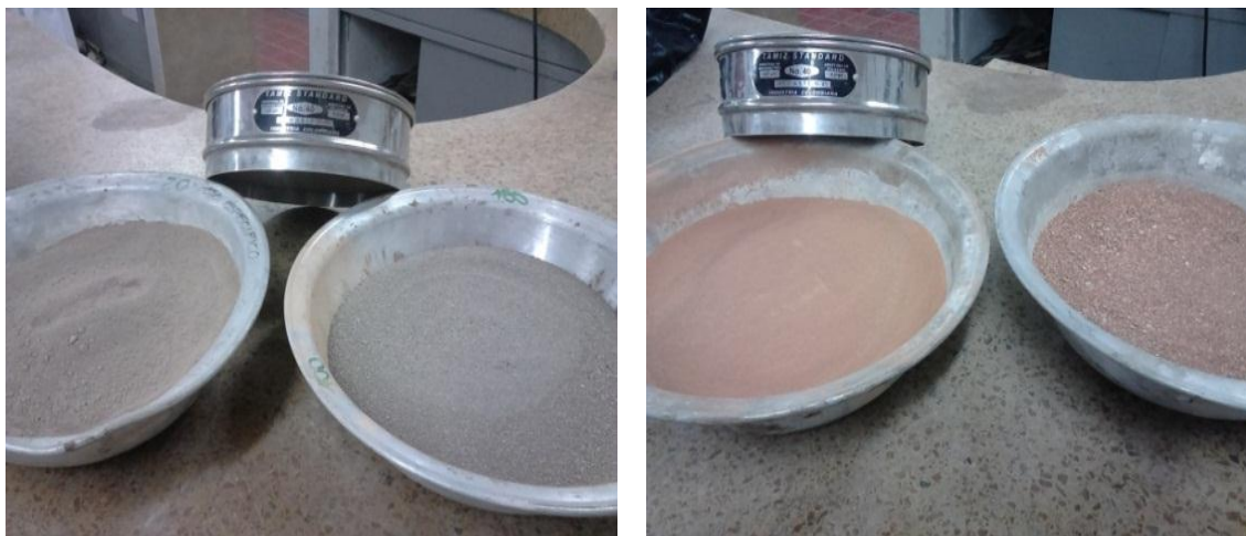
Figura 34 Tamizado del material
