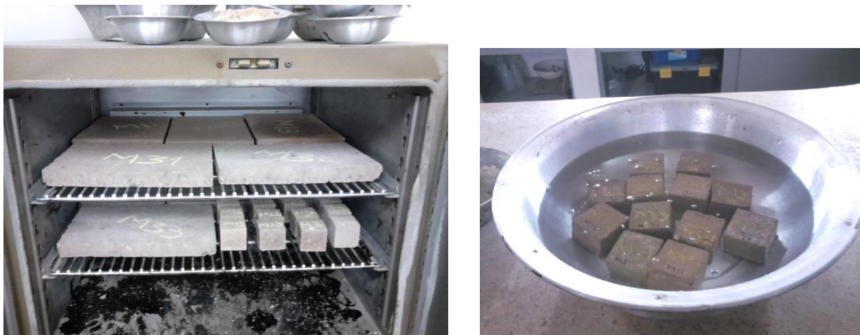
Figura 38 Procedimiento Absorción de agua. Autor
