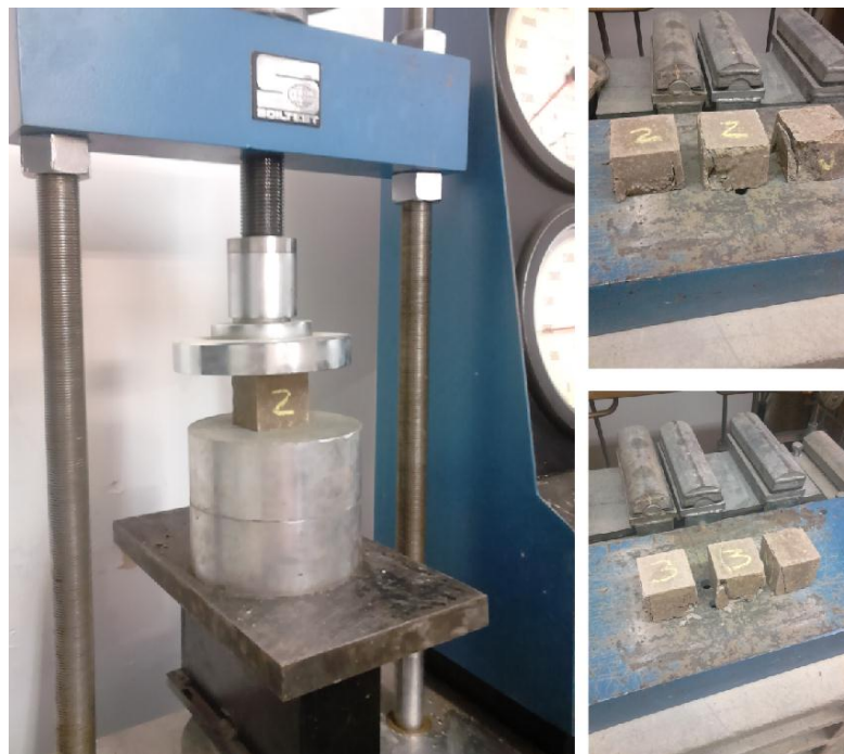
Figura 37 Procedimiento prueba a compresión. Autor
