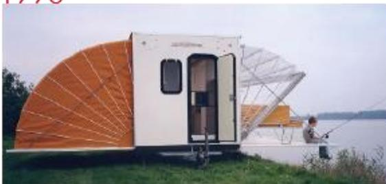
una vez que la unidad llega a su destino, las paredes se despliegan hacia abajo para crear suelos y el nuevo espacio queda dentro de una estructura de membrana en acordeón.
