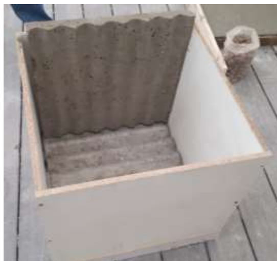
Figura 12. Caja de pruebas con un panel de arlita – 2018.
