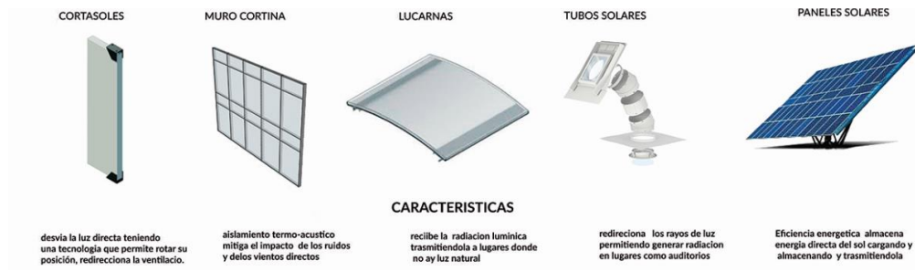
Ilustración 34 Tipología y perfilaría implementada en las estrategias bioclimáticas
