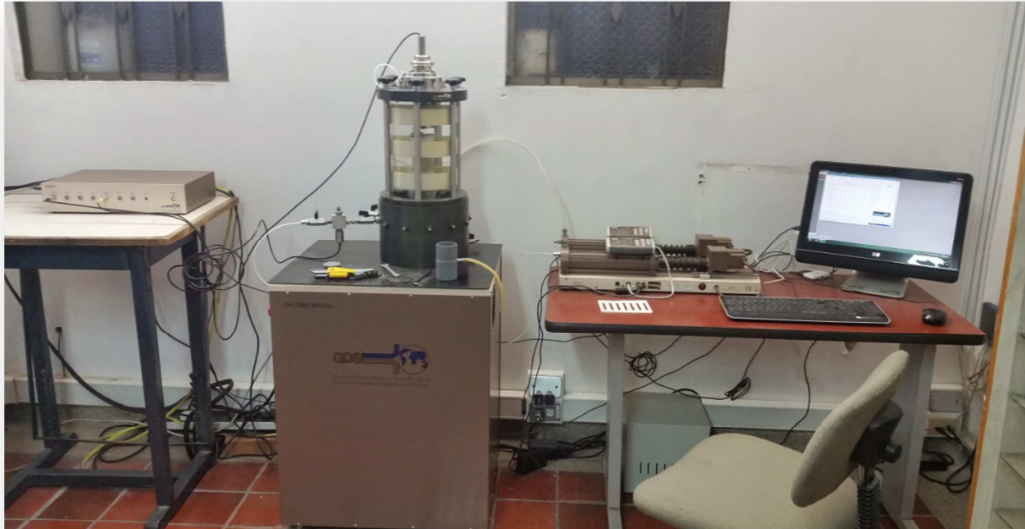
Ilustración 3 Unidad de registro de información y unidad de aplicación de carga y Unidad de regulación de presión universidad la Gran Colombia
