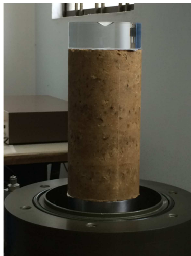
Ilustración 7 Inicio de montaje de la muestra compactada en cámara triaxial
