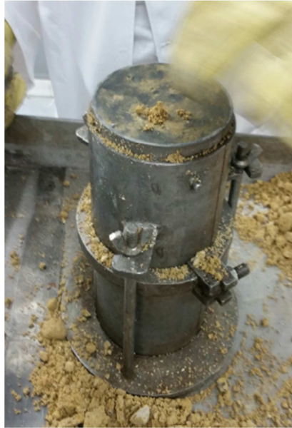
Ilustración 6 Muestra compactada y enrasada en el molde
