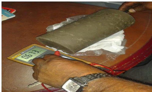
Fotografía 6. Medición de la resistividad eléctrica del concreto por el método directo. 27 de febrero de 2015.
