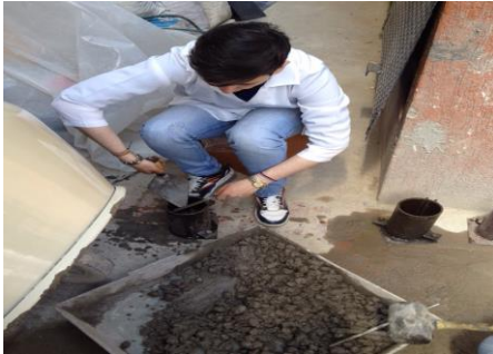
Fotografía 15. Realización de cilindros de concreto con piedra pómez saturada. Tomado 27 de Febrero de 2015.
