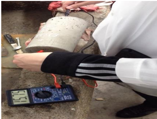
Fotografía 20. Medición de resistencia con multímetro marca TMC-80. Tomada 3 de Marzo de 2015.
