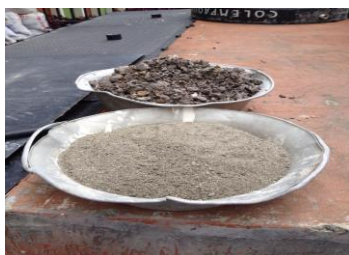
Fotografía 11. Cantidades de piedra pómez saturada y cemento para 5 cilindros. Tomado 27 de Febrero de 2015.
