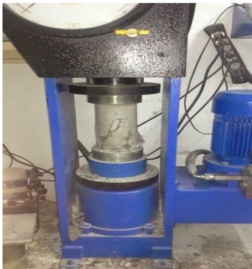
Fotografía 5. Falla de cilindro de concreto en prueba de resistencia a la compresión. 26 de marzo de 2015.
