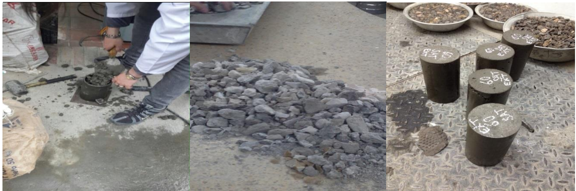
Fotografía 1. Concreto ligero, piedra pómez y curado interno. Tomada 27 de Febrero de 2015.
