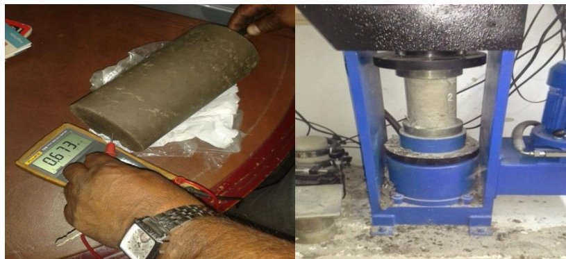
Fotografía 2. Resistividad eléctrica y resistencia a la compresión. Tomada 26 de Marzo de 2015.
