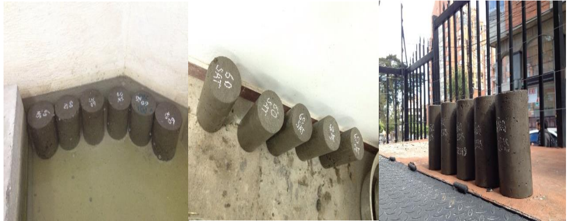
Fotografía 19. Grupos de probetas en sus diferentes condiciones de curado; curado convencional (lado izq.); curado interno bajo techo (centro) y curado interno expuesto al ambiente (lado der.). Tomada 28 de febrero de 2015.
