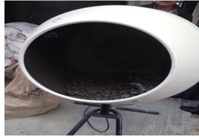
Fotografía 14. Mezcla de concreto con piedra pómez saturada. Tomado 27 de febrero de 2015.
