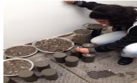
Fotografía 18. Marcación de cilindros de concreto. Tomado 28 de febrero de 2015.
