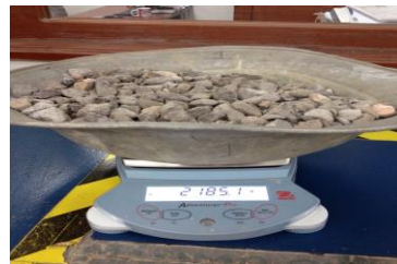
Fotografía 8. Pesaje de muestra triturada para tamizar. Tomada 25 de febrero de 2015.
