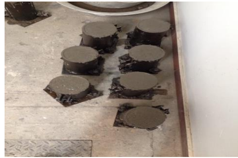
Fotografía 16. Probetas de concreto encofradas. Tomado 27 de febrero de 2015.
