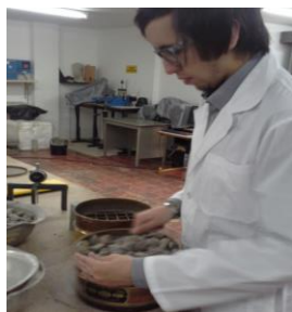
Fotografía 9. Tamizado de muestra de material triturado. Tomado 25 de Febrero de 2015.
