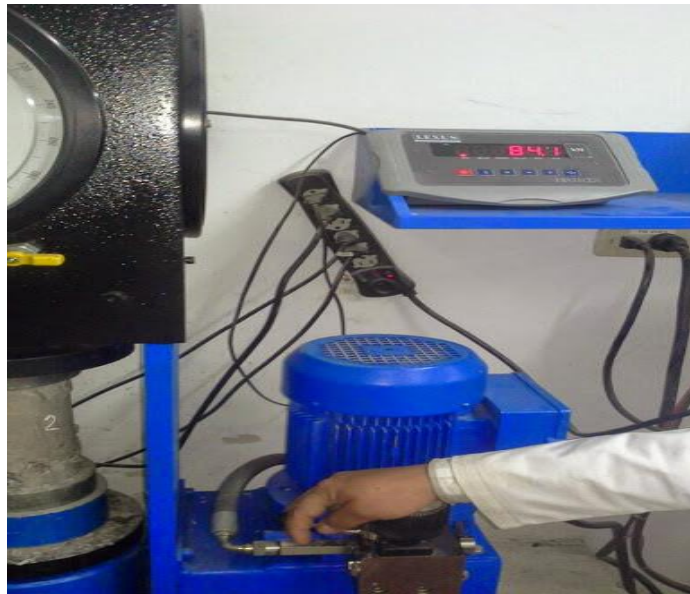
Fotografía 4. Esquema para determinar la resistencia a la compresión del concreto. 26 de marzo de 2015.
