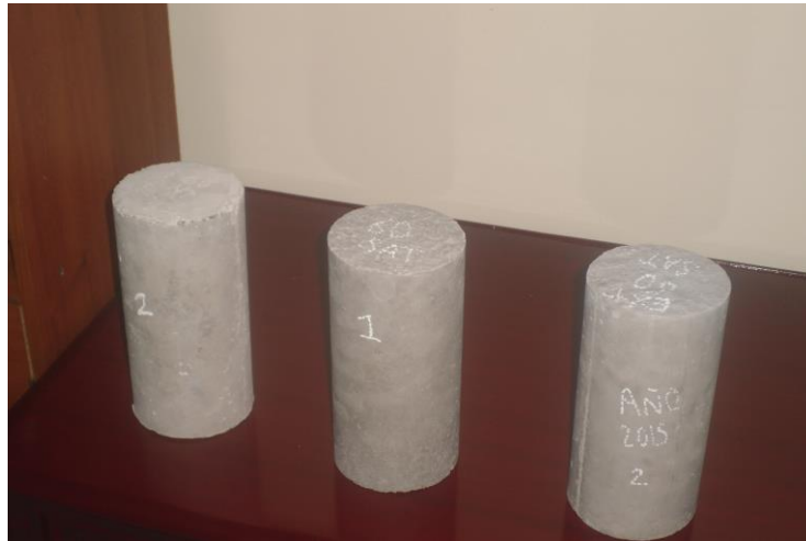
Fotografía 23. Probetas a la edad de 49 días de edad, expuesta a curado convencional (izquierda), curado interno bajo techo (centro) y curado interno expuesto al ambiente (derecha). Tomada 16 de Abril de 2014.
