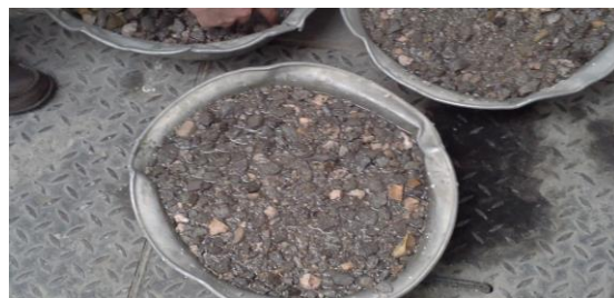
Fotografía 10. Saturación de muestras de piedra pómez para probetas sometidas ha curado interno. Tomado 25 de febrero de 2015.
